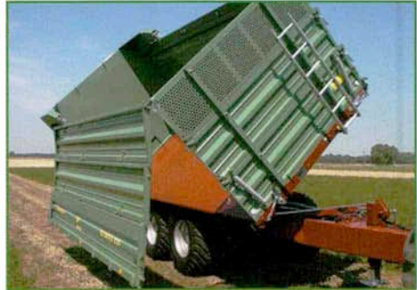
Seitliche Pendelwand mit Zentralverriegelung und angebaute hydraulischer Rückwand
