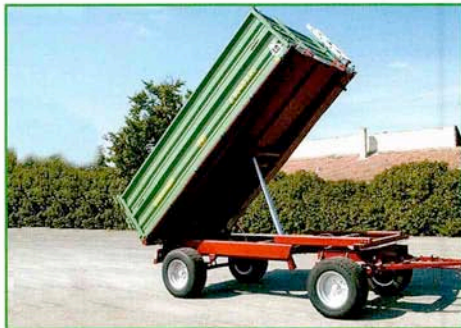
2-Achs-3-Seitenkipper mit 8 t Gesamtgewicht: Z 8045 XXL
