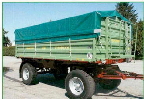
Planenaufbau mit Bedienplattform und klappbarer Planenstange; Plane über Aufsatzwände gezogen, dadurch kein Eindringen von Wasser möglich
