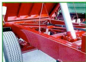
Doppel-C-Profil bei 18-t-Kipper
