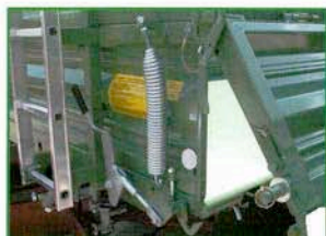
Pendelwand mit Zentralverriegelungshebel
