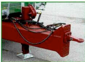
Anhängung mit höherem Verstellbereich der Zugöse
