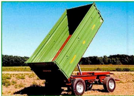
Preiswerte Alternative: Doppel-T-Rahmen (nur bei Z 18050/1)
