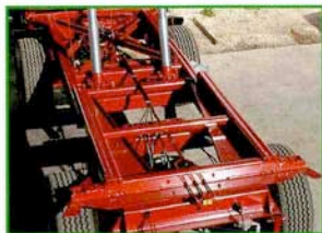
Stabiler Fahrgestellrahmen mit Kreuzversteifungen und großem, schwerem LKW-Drehkranz
