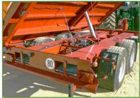
TA 11045 Tieflader mit Möglichkeit zum Einschleppen von Auffahrampen
