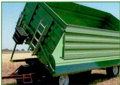
Mechanische Bordwandöffnung 90 Grad (nur bei 2-Seiten-Kipper)
