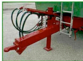
Untenanhängung mit Zugrohr aus Doppel-□-Pressprofil
