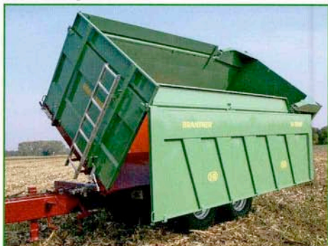
Stabilatoraufbau seitlich pendelbar mit aufgebauter Rückwandöffnung und Silageaufsatzwänden
