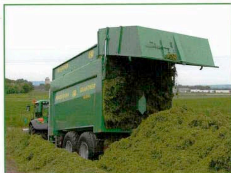
Tiefe Rückwand für zusätzliches Ladevolumen serienmäßig
