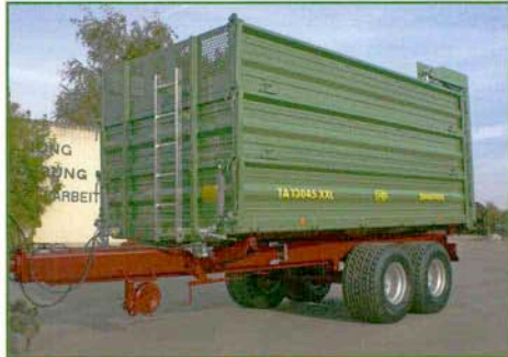
TA 13045 XXL mit hydraulischer Rückwandöffnung und Aufbau 3 x 600 mm, Spur 1950 mm, Bereifung 505/50 R 17
