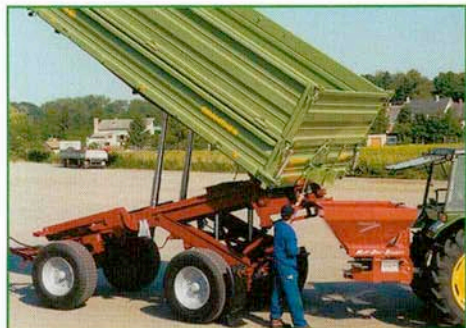
Hochkippeinrichtung für 2-Achs- und Tandemkipper
