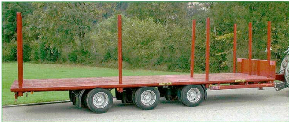
Tridem-Plattformwagen mit Zwillingsbereifung, Luftfederung und Rungen aus Rundrohr
