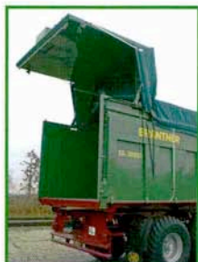
Hydraulische Rückwandöffnung kann sowohl bei geschlossener als auch bei aufgerollter Plane geöffnet werden.
