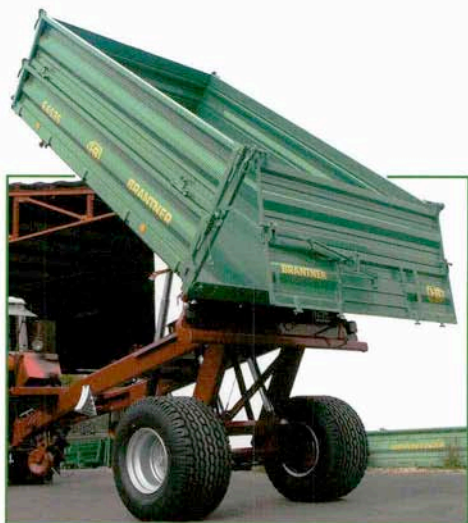
1-Achs-Kipper mit Hochkippeinrichtung und Breitreifung 505/50 R 17
