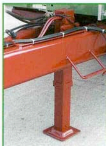
Hydraulische Abstützung mit geschütztem, senkrecht doppelt wirkendem Zylinder (Rohr-im-Rohr-System)
