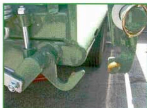
Schließhaken mit 30 mm Heranholvermögen hinten und vorne
