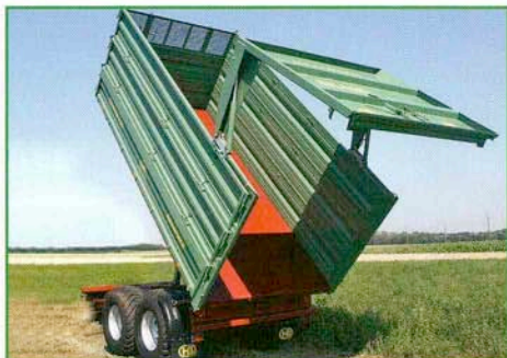
Hydraulische Rückwandöffnung doppelwirkend, mechanisch verriegelt, mit Sperrblock gesichert
