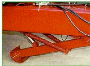
Hydraulische Abstützung mit geschütztem, einfach wirkendem Zylinder mit Rückzugsfeder
