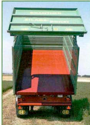
Konische Kipperbrücke (bis zu 10 cm breiter) für schnellere Entleerung
