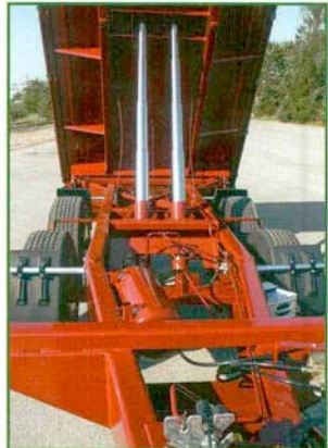
Breiter robuster V-Rahmen, Fahrgestell aus hochwertigen Profilen. Breite Federspur für optimale Standsicherheit und geringe Belastung der Achse
