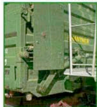
Hydraulic side wall opening Гидравлическое раскрытие бортов Hidraulikus kocsifalnyitás Deschidere hidrolică a oblonului
