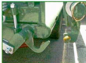
Closing hook with 30 mm purchase range Запирающий крюк с диапазоном подтягивания 30 мм Záróhorog 30 mm-es ráhúzási lehetőséggel Cârlig de închidere cu posibilitate de apropiere de 30 mm
