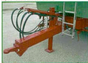
Lower hitching-up with drawtube нижняя сцепка с тяговой трубой Alsó ráakasztás vonócsővel Cuplaj remorcare în partea inferioară cu bară de tracțiune
