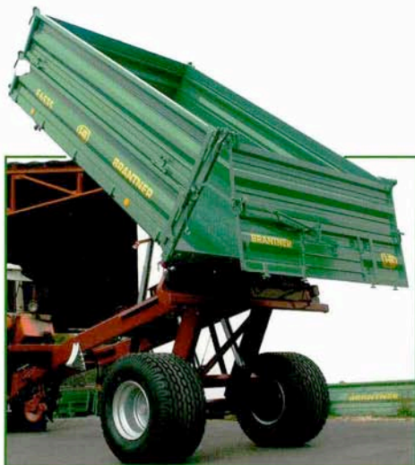
Single-axle tipper with high tipping facility Одноосевой самосвал с механизмом высокого опрокидывания Egytengelyes billenés felengedővel felszállított berendezés Semiregészrű bázisú, a szinglű pontre cu instalatie de basculare prin ridicare
