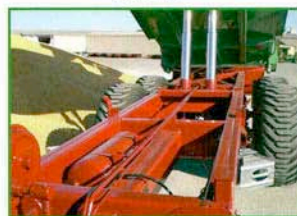
Double C-profile rectangular frame Прямоугольная рама с двойным C-образным профилем Téglalap alakú, kettős C-profilű keret Șasiu dreptunghiular în profil dublu C
