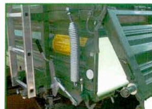
Pendulum wall with central locking lever Откидной борт с центральным запорным рычагом Lengőfal központi reteszelőkkal Perete oscilant cu levier central de fixare
