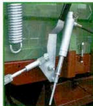
Hydraulic pendulum wall unlocking Гидравлический механизм разблокировки откидных бортов Hidraulikus lengőfal kiloldás Deblocare hidrolică a peretelui oscilant
