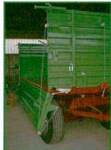
Side wall lifting facility with cable winch Подъемное устройство бортов с лебедкой Kocsifal emelő berendezés kábelcsővel Instalație de ridicare oblon cu troliu
