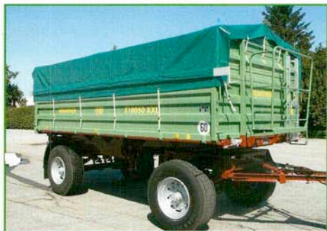
Tarpaulin body with operating platform and fold-type tarpaulin bar Тентовый кузов с платформой управления и складной тентовой стойкой Ponyvás felépítmény kezelőpódiummal és billenthető ponyvarúddal Construcție caroserie prelată cu platformă de deservire și bară pliantă pentru prelată
