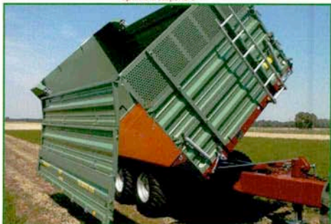
Lateral pendulum wall with attached hydraulic rear wall боковая откидная борта с закрепленной гидравлической задней стенкой Oldalsó lengőfal rászerezett hidraulikus hátfallal Perete lateral oscilant cu perete posterior hidraulic anexat
