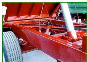
Double C-profile chassis frame Рама шасси с двойным С-образным профилем Kettős C-profilű alvázkeret Șasiu în profil dublu C
