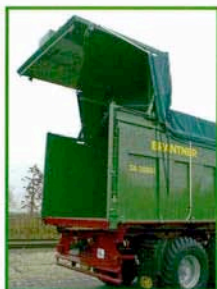
Hydraulic rear wall opening with tarpaulin body Гидравлическое раскрытие задней стенки с тентовым кузовом Hidraulikus hátfal nyitás ponyvás felépítménnyel Deschidere hidraulică a peretelui posterior, cu prelată
