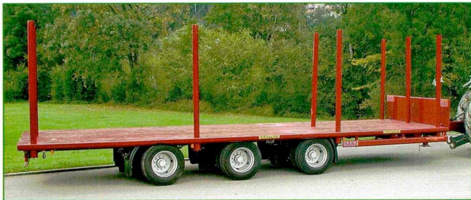
Tridem platform wagon with air suspension Строенный грузовик-платформа с пневматической подвеской Légrugózású tridem platós kocsi Remorcă platformă tridem cu suspensie cu aer
