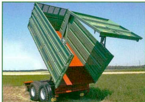
Hydraulic rear wall opening double-acting Гидравлическое раскрытие задней стенки двойного действия Hidraulikus hátfal nyitás, kettős hatású Deschidere cu dublu efect, hidraulică a peretelui posterior
