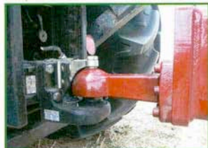
Flange pulling eye for ball coupling фланцевые тяговые проушины для шариковой муфты Kötéses húzófül a göyös csatlakozató elemhez Ureche de tractare pentru cuplaj cu bilă
