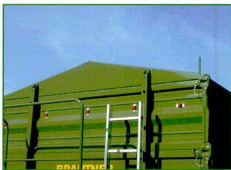
Attachment triangles 300 mm high Надставные треугольники высотой 300 мм 300 mm magas magasító háromszögek Triunghiuri suplimentare înălțime 300 mm
