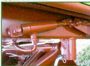
Hydraulic pendulum wall unlocking rear Гидравлический механизм разблокировки откидных бортов сзади Hidraulikus lengőfal kioldás hátul Deblocare hidrolică perete posterior oscilant
