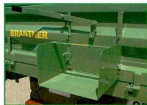
Drain gutter cannot be locked Выпускной лоток не запирается Nem zárható kifolyógarat Gură de evacuare nu poate fi blocată
