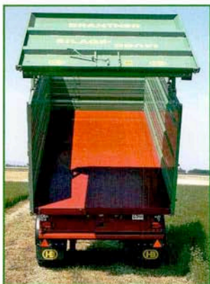
Taper tipper bridge – up to 10 cm wider conicneski opširođivajemyj most – širine pošta na 10 cm Kúpos billenőhid – a legszélesebb részen 10 cm-rel szélesebb az egyenes kivitelei Punte conică de basculare – până la 10 cm mai lăta
