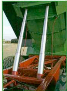
Hard-chromed tipping cylinder – no rust hazard Твердохромированный опрокидывающий цилиндр – нержавеющей Keménykrómozott billentőhengerg – nincs rozsásodási veszély Cilindru de basculare cu cromare dură – nu există pericol de oxidare
