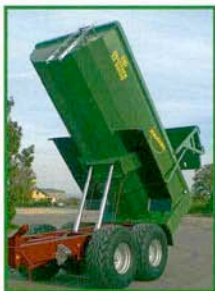
Half-Pipe version of Hardox 450 – 6 mm thick Исполнение Half-Pipe из Hardox 450 – толщина 6 мм Hardox 450 anyagból készült Half-Pipe kivitel – 6 mm vastag Execuție Half-Pipe din Hardox 450 – grosime 6 mm
