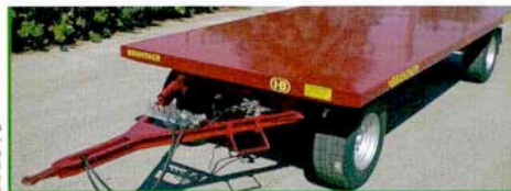
Tridem platform wagon with air suspension Строенный грузовик-платформа с пневматической подвеской Légrugózású tridem platós kocsi Remorcă platformă tridem cu suspensie cu aer
