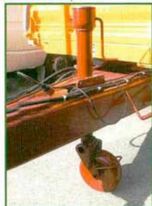
Support wheel with angle gear опорное колесо с конической передачей Támaszkerekek szögajtással Roată de sprijin cu reductor unghiular
