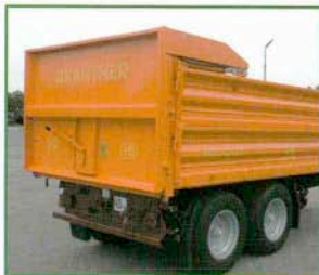
Tandem mit hydraulischer Rückwandöffnung
