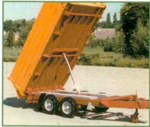
Tandem-Tieflader mit einschiebbaren Alu-Schienen
