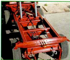
Stabiler Fahrgestellrahmen mit Kreuzversteifungen und großem, schwerem LKW-Drehkranz
