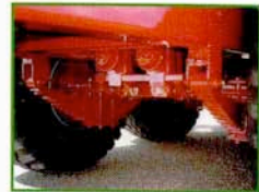
Blattfederung unter der Achse (ab 14 t), dadurch niedrige Bauhöhe, tiefer Schwerpunkt und damit ausgezeichnete Standsicherheit in allen Lagen
