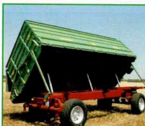
2-Seitenkipper mit mechanischer Bordwandöffnung 90 Grad
