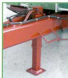
Hydraulische Abstützung mit geschütztem, senkrecht doppeltwirkendem Zylinder (Rohr-im-Rohr-System)
