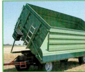
Mechanische Bordwandöffnung 90 Grad (nur bei 2-Seiten-Kipper)
