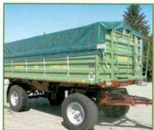
Planenaufbau mit Bedienplattform und klappbarer Planenstange
