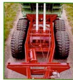
Breiter robuster V-Rahmen, Fahrgestell aus hochwertigen Profilen, Breite Federspur für optimale Standsicherheit
