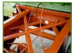
Kreuzversteifung für zusätzliche Rahmenstabilität und bessere Standsicherheit
