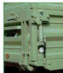
Automatische hydraulische Bordwandöffnung 180 Grad
