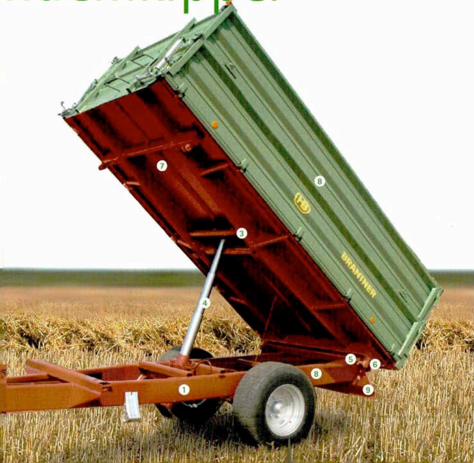
Konische Kipperbrücke (bis zu 10 cm breiter) für schnellere Entleerung
