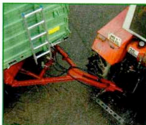
Y-Deichsel für optimalen Einschlagwinkel
