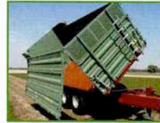
Seitliche Pendelwand mit Zentralverriegelung und angebauter hydraulischer Rückwand
