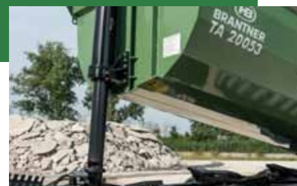
Frontcylinder Hårdforkromet for særlig høj løftekraft og en hælningsvinkel på over 50 grader
