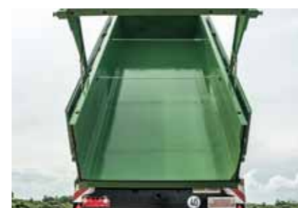
Konisk kasse for at lette aflæsning.
