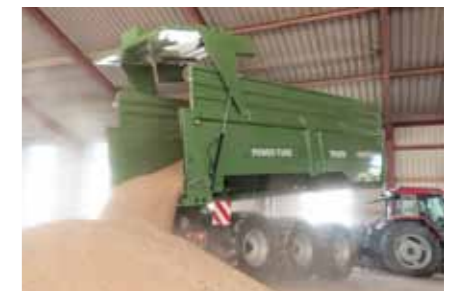
TR 34080/2 PT+ 34 t totalvægt, med mulighed for hydraulisk-mekanisk eller elektrisk tvangsstyring
