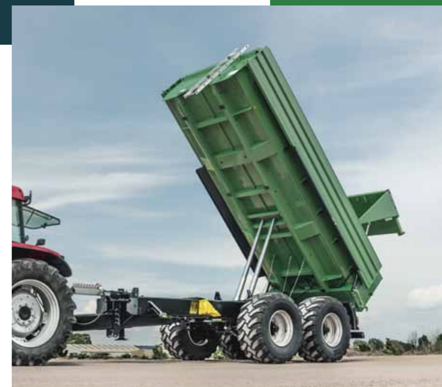
TA 22065/2 XPT+ Stærke aksler med 32 ton affjedringsenhet, kugletræk K80 for 4 tons trækøjevægt
