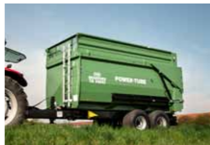
TA 14045/2 PT+ Med 2 tipcylindre for optimal stabilitet ved tipping
