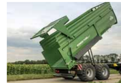
TA 24080/2 PT+ Karosserilængde 8000 mm, med luftaffjedring og automatisk sænkning af kip som standard
