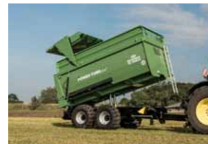
TA 20053/2 PT+ Med konisk kasse, fremstillet af 4 mm tyk stålplade
