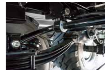
Fjederstabilisator Anbefales kraftigt til styreakslen (kun muligt med parabolisk affjedring)
