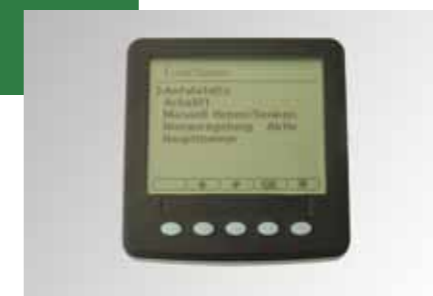
HP premium control Løft af forreste aksel, startassistance osv. (hydraulisk affjedring)
