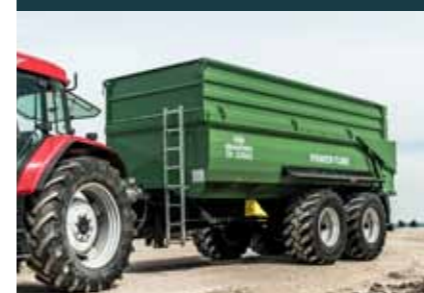
TA 22053/2 XPT+ Gennemgående 6 mm stålplade, højde 1000 mm
