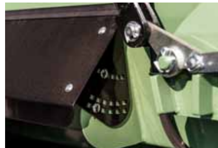
Hjulafskærmning indstillelig for optimal tilpasning
