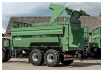
Nedklappelige overbygningssider Hydraulisk bagsmæk kan også anvendes med nedklappet sider.
