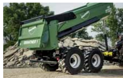
Bagsmæk Hydraulisk dobbeltvirkende med både pendul- og løftfunktion
