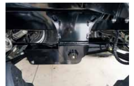
Forskudt tandem aksel Affjedring på styrende aksel for bedre stabilitet ved kørsel og tipning
