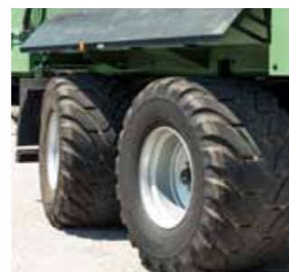
meddrejende aksel med låsefunktion
