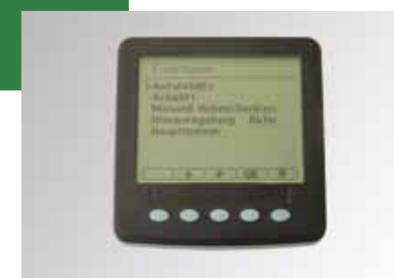
**HP Premium Steuerung** Liftachse, Anfahrhilfe, etc. (Hydraulikfederung)
