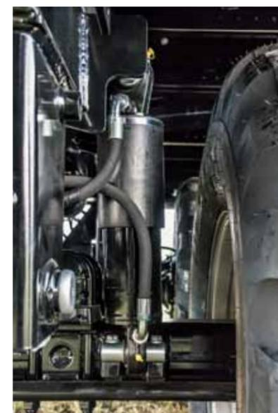
**Hydraulikfederung** höchstmögliche Kurven- und Hangstabilität
