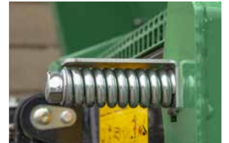
Kettenspanner federbelastet mit Anzeige an der Stirnwand
