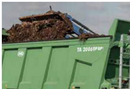
Schutzkante Bei der Beladung wird die Ladekante mit einer Kunststoffverschleißleiste gegen Beschädigungen geschützt.
