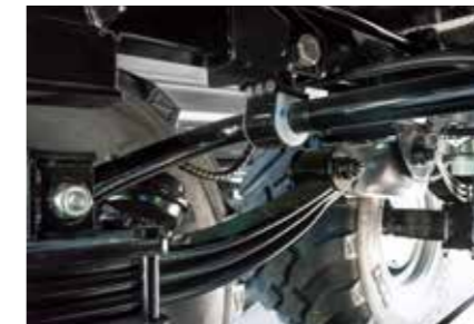
Federstabilisator sehr zu empfehlen bei Lenkachse (nur bei Parabelfederung möglich)
