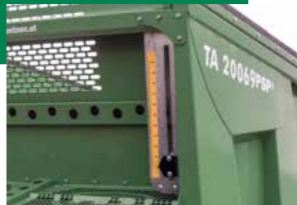
Stauwandanzeige an der Stirnwand mit versteckter Seilführung schützt vor Schmutzablagerungen und Funktionsstörungen
