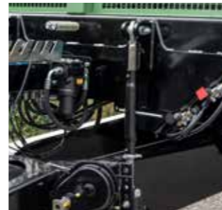
Anhängenhöhe über Spindeln verstellbar
