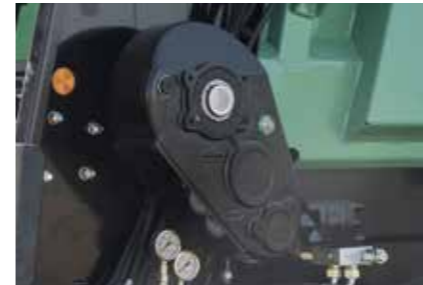
Kratzbodenantrieb hydraulisch über Ölbadgetriebe und hydraulische Überlastsicherung
