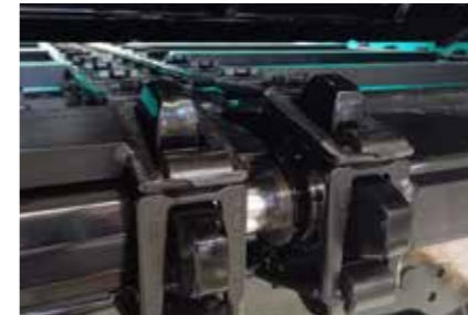
Kettenstränge mit Flachgliederkette anstatt Rundstahlkette (Option)
