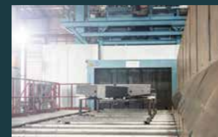
Strahlen mechanische Vorbehandlung für saubere und homogene Oberflächen
