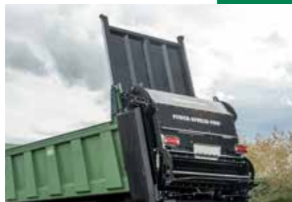
Schräge Stauwand bessere Ausnutzung des Ladevolumens und perfektes Streubild von Anfang an
