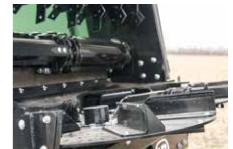
Streuteller aus 10 mm Hardox und 6 verstellbaren Streuschaufeln
