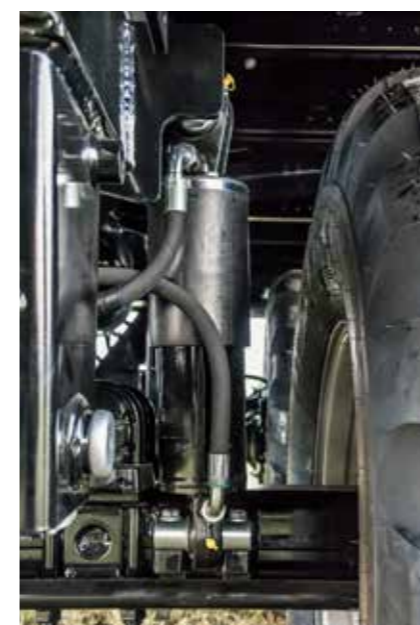
Hidraulikus rugózás maximális kanyarodás és lejtőstabilitás
