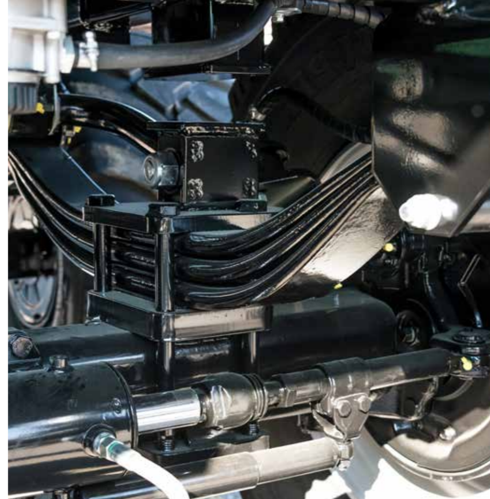
32 tonnás rugók erősített felfüggesztéssel
