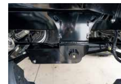
Eltolt tandem egység a felfüggesztés kormányzáshoz beállítva, a jobb stabilitás érdekében
