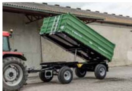
Z 8045 XXL med overløbsbremse og 500 mm overbygning
