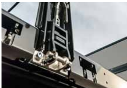
Midterstolpe kan afmonteres uden værktøj - særligt nyttigt ved læsning af kasser eller paller
