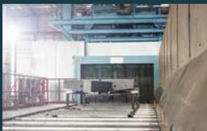
Mekanisk forbehandling med sandblæsning til rene og homogene overflader
