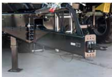
Højdejusterbar trækstang fremstillet af dobbelt-C pressede profiler
