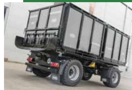
Aflæsningsstøtte til skånsom aflæsning af følsomme bulkvarer (f.eks. kartofler)
