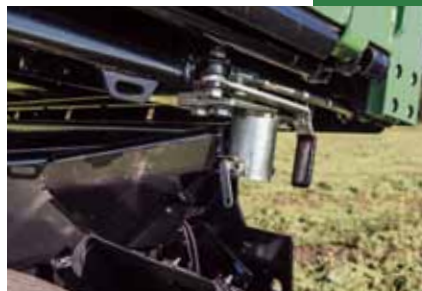
Tippepunkter placeret i maksimal bredde for at sikre endnu bedre stabilitet
