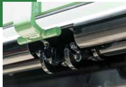
Sidehængsler med dobbeltlås (fra 5 m platformlængde)
