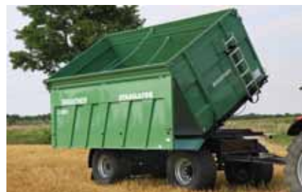
glatte indervægge det koniske plateau og de helt glatte indervægge giver en hurtig og effektiv aflæsning.
