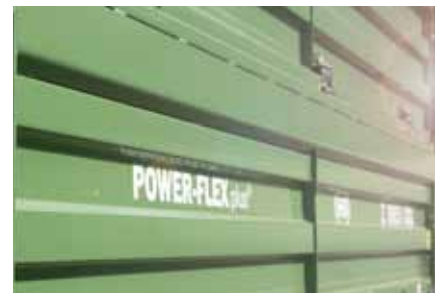
Overbygningsforstærkning af 6 mm stålplade med svejset kasseprofil
