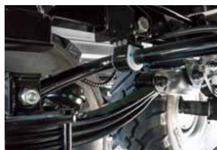
Fjederstabilisator fås som ekstraudstyr, anbefales til styrende aksler
