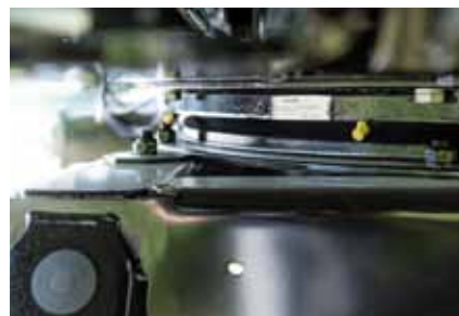
Kuglelejret drejeskive Kraftig kuglelejret drejeskive kendt fra lastvognskonstruktioner
