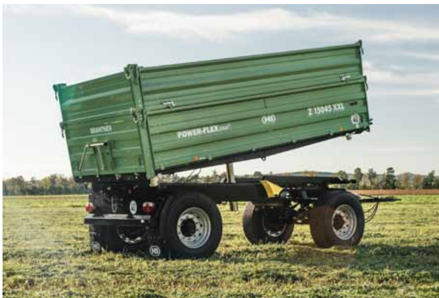
Z 15045 XXL AKTION Mulighed: PROFI-pakke med 2 tipcylindre, sidepladeforstærkning, sideplade løftefjedre og 5 mm stålblade
