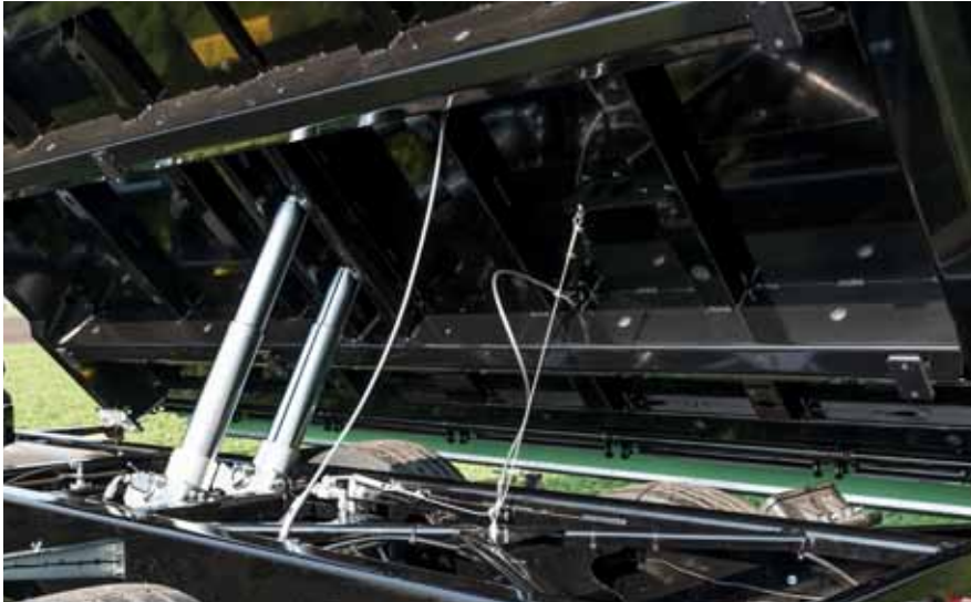
Tipramme standard som lastvognskonstruktion
