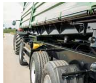
Tippamme standard som lastvognskonstruktion. Tippunkter i maksimal bredde
