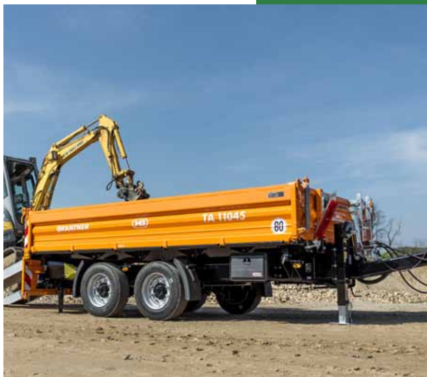
TA 11045 low loader mulighed for brug af læsseramper.
