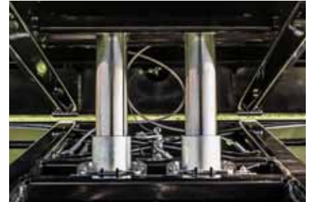
Hårdtforchromede tipcylindre monteret på drejelige støtter, afhængig af vogntype.
