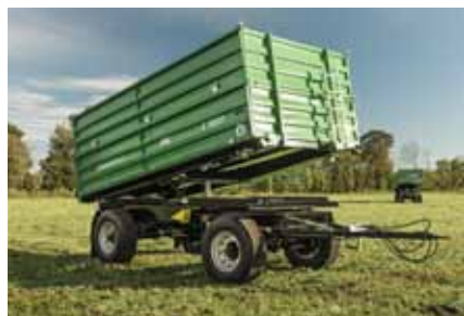
Z 18051 AKTION indgangsmodel i gennemprøvet Brantner-kvalitet med en standard dobbelt-C-profilramme
