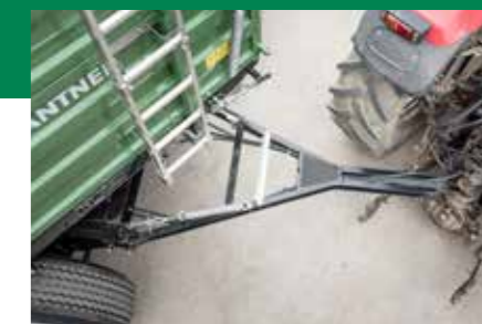
Vonórúd Y-vonórúd az extrém fordulási sugárért
