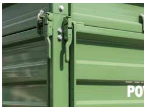
Hestal zárok, oldalfalerosítés nélkül
