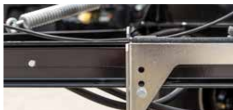
U-profil 100 mm-el, 2x26 tonnához
