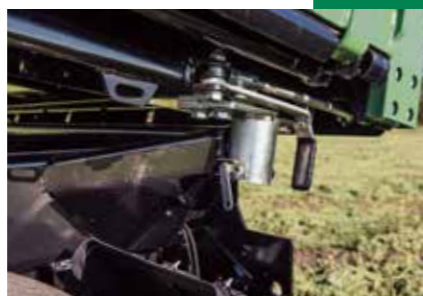
Széles, golyós billentő platótámasz a nagyobb stabilitásért
