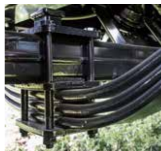
Parabola felfüggesztés tengely alatt
