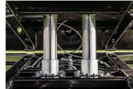
Keménykrómozott billentő munkahenger kivittől függően egy vagy két darab
