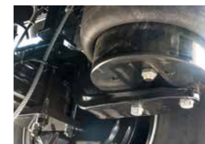
Megerősített rugózás forgószámo- ly tengelyen az optimális stabilitás és terepen való mobilitás érdekében
