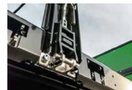
Szerszám nélkül eltávolítható középső rakonca – hasznos lehet dobozok vagy raklapok rakodásakor
