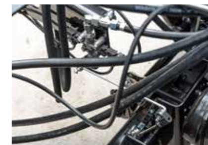
Pneumatikus fékerőszabályzó gondoskodik a fékerő megfelelő beállításáról
