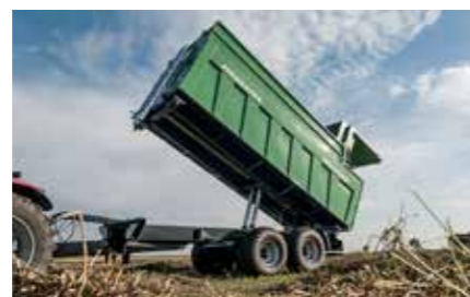
Hidraulikus hátsó fal opcionálisan hidraulikusan nyitható hátsó fal
