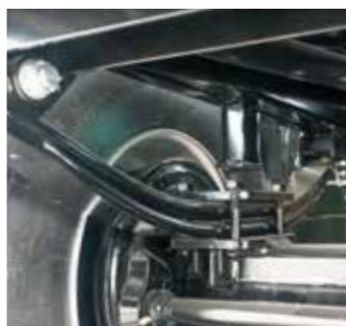
Parabola felfüggesztés tengelyen
