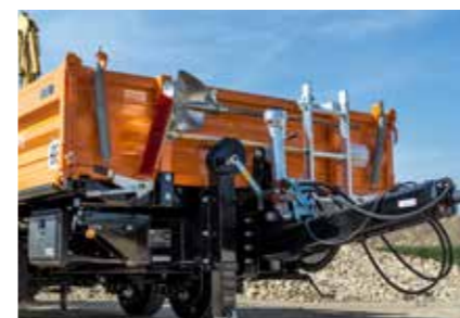
TA 13045 alacsony platós pótkocsi alapkivitelben állítható magasságú vonórúddal, opcionálisan lapáttal és seprűtartóval
