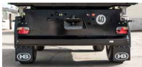
Multi-Point világítás, sárvédő gumikkal a kerekeknél
