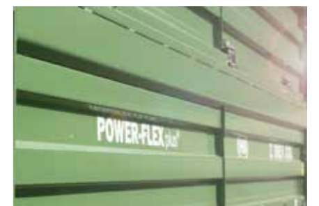
Oldalfal merevítés 6 mm-es acéllemezről hegesztett profillal
