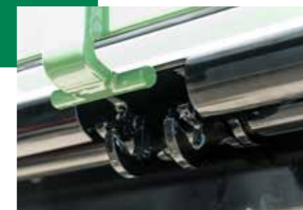
Oldalsó zárófülek 5 m platóhossztól dupla reteszeléssel
