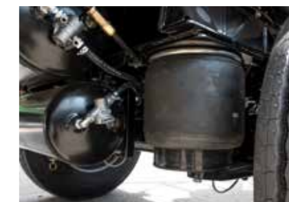
Automatikus szintszabályozás a kellemes vezetési élményért
