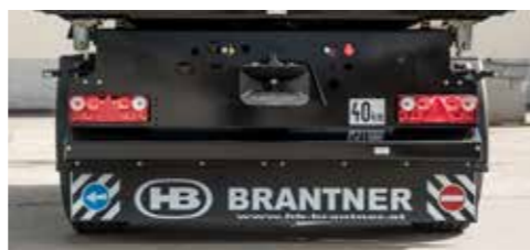
Europoint II. világítás, a pótkocsi teljes szélességében sárvédő gumival
