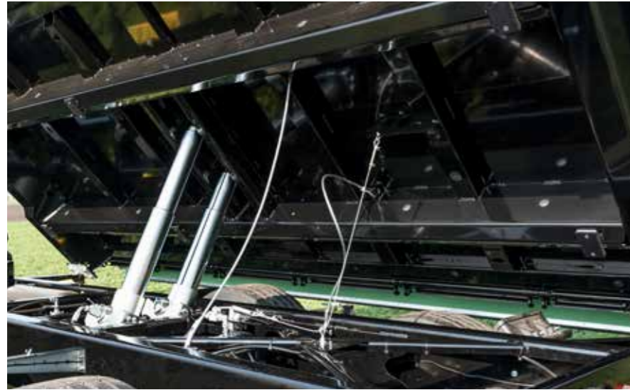
Trapéz billentőkeret a teherautó kialakításnak megfelelően merevítőkkal
