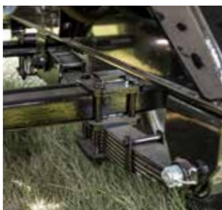
Laprugós felfüggesztés a tengely alatt
