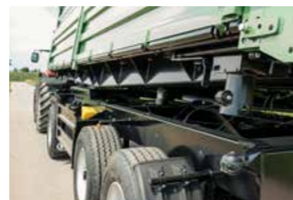
Trapéz billentő alvázkeret a teherautó kialakításának megfelelően, széles billentő csuklós platótámasz
