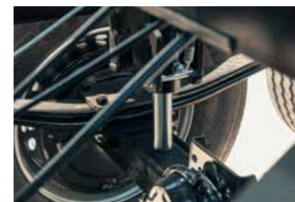
Hidraulikus hátsó tengelytámasz, az optimális rugózási komfortért
