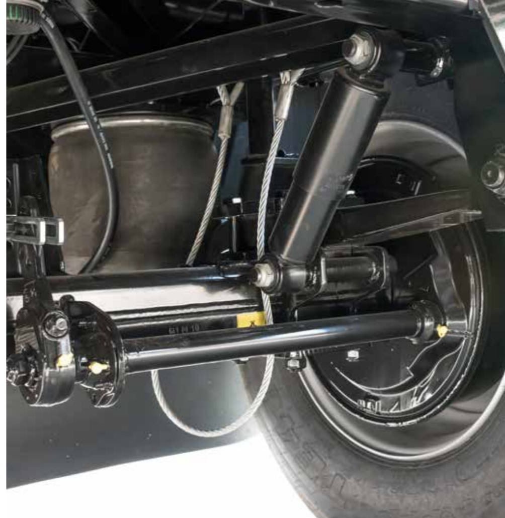
Normál teherautó légrugózás len- gécsillapítóval
