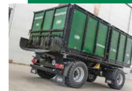
Csúszda ömlesztett áruk (pl. burgonya) optimális leöntéséhez
