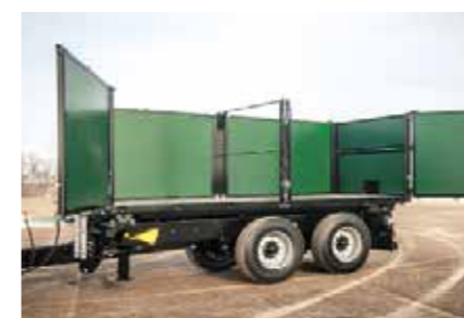
Portálajtó szabványos portálajtó a bal oldalon (opcionálisan jobb oldalon is lehetséges), oldalra nyílóan szerelhető
