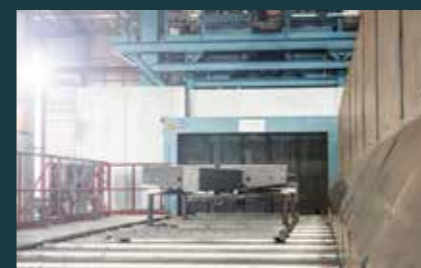
Fémgolyó szórásos mechanikus előkezelés a tiszta és homogén felületekhez
