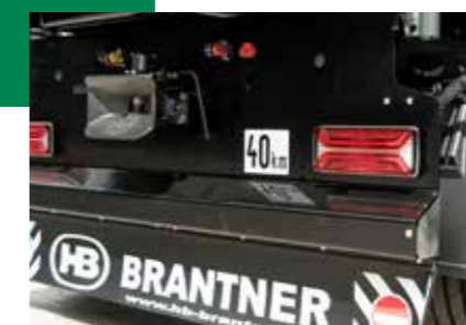
Világítás alapkivitelben Agriled full LED-es hátsó lámpával, irányjelzővel
