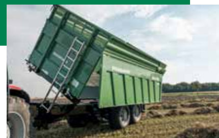
Ingafal bal és jobb oldali inga rögzítésű stabilizátor falak, könnyen nyitható
