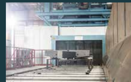
Mehanički predtretman peskarenjem za čiste i homogene površine
