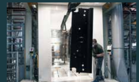
Automatsko farbanje nanošenjem praha
