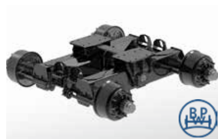
BPW klatna jedinica sa ojačanim osovinama kvadrata 150 x 20 mm, kočnica 410 x 180 mm
