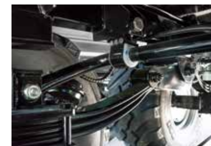
Veoma preporučljivi opružni stabilizator za upravljačku osovinu (moguće samo sa paraboličnim ogibljenjem)
