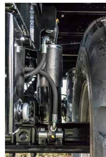
Hidraulično oslanjanje, najveća moguća stabilnost krivine i nagiba
