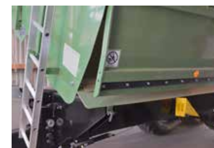
Klizač za nežno istovarivanje preko bočno preklopnog klizača
