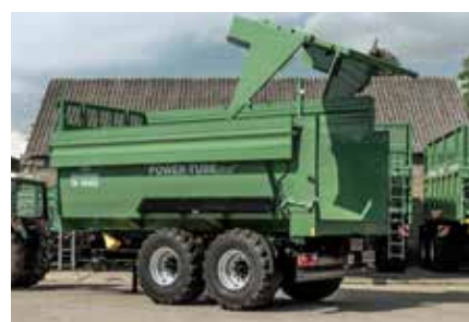
sklopivi pričvrtni zidovi, hidraulični zadnji zid se može otvoriti kada se gornji zidovi preklope
