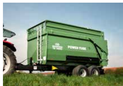
TA 14045/2 PT+ sa 2 cilindra za optimalnu stabilnost kpanja
