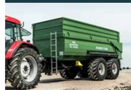
TA 22053/2 XPT+ kontinuirani čelični lim od 6 mm, visina 1000 mm
