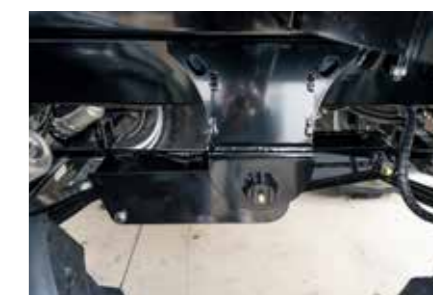
podesiva offset tandem jedinica suspenzija na upravljačkoj osovini, bolja stabilnost i smanjenje sklonosti kotrljanja
