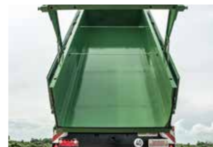
konusni otvor za lakše ispuštanje tereta
