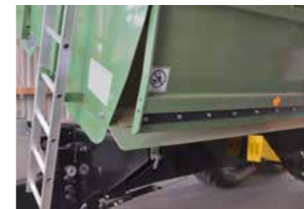
Klizač za nežno istovarivanje preko bočno preklopnog klizača
