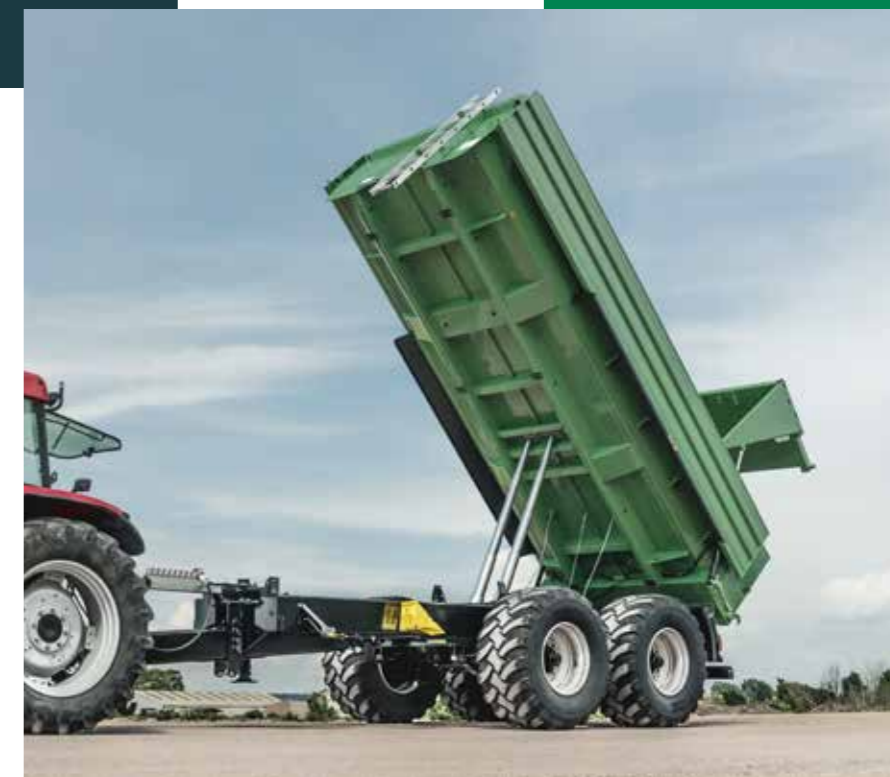
TA 22065/2 XPT+ Jake osovine sa vešanjem od 32 t, ušicom za vuču pribornice K 80 za opterećenje vučne rude od 4 t
