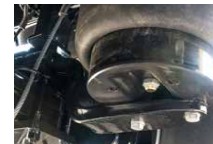
Vazdušno vešanje sa upravljačem sa dve oštrice za optimalnu stabilnost i pokretljivost van puta
