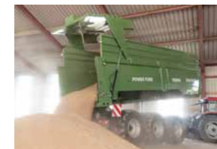
TR 34080/2 PT+ 34 t ukupne težine, sa hidraulično-mehaničkim ili električnim aktivnim upravljanjem po u opciji
