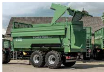
sklopivi pričvrtni zidovi, hidraulični zadnji zid se može otvoriti kada se gornji zidovi preklope
