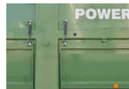
Opdelte sider for større stabilitet i kassen
