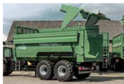
Nedklappelige overbygningssider Hydraulisk bagsmæk kan også anvendes med nedklappet sider.
