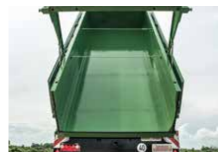
Konisk kasse for at lette aflæsning.
