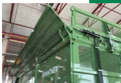
Hydraulisk foldbar sider valgfrit i venstre eller højre side
