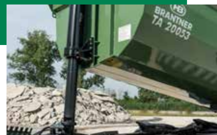
Frontcylinder Hårdforkromet for særlig høj løftekraft og en hældningsvinkel på over 50 grader
