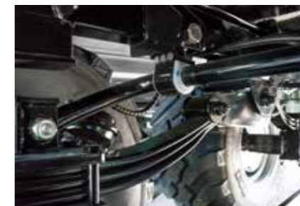
Fjederstabilisator Anbefales kraftigt til styreakslen (kun muligt med parabolisk affjedring)
