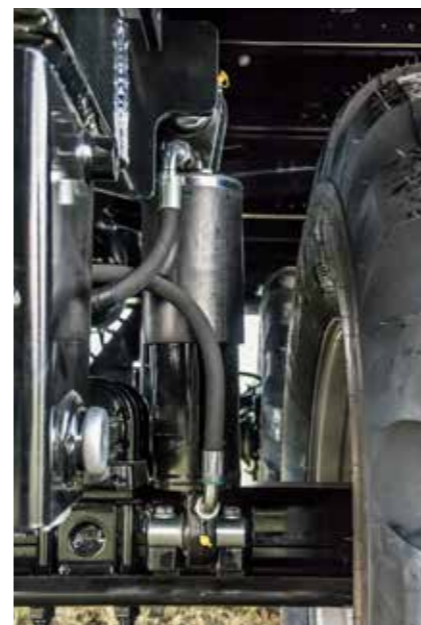
Hydraulisk affjedring Størst mulig stabilitet i kurver og på skråninger
