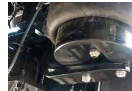
Luftaffjedring Med dobbelt funktion for optimal stabilitet.
