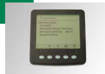
HP premium control Løft af forreste aksel, startassistance osv. (hydraulisk affjedring)
