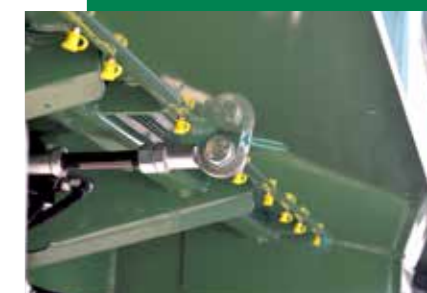
Innovation fra BRANTNER Hydraulisk styret pendulfunktion til åbning og lukning
