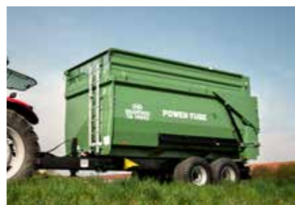
TA 14045/2 PT+ s 2 výklopnými válci pro optimální stabilitu při sklápění
