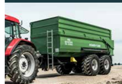
TA 22053/2 XPT+ vyrobená výhradně z ocelového plechu o tloušťce 6 mm, výška 1000 mm
