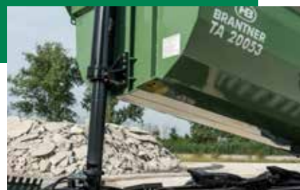
Tvrdo pochromovaný přední válec pro obzvláště vysokou zvedací sílu a úhel sklonu přes 50 stupňů
