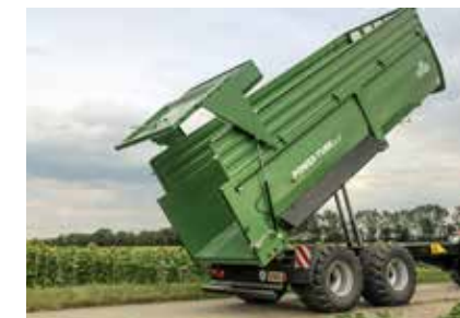
TA 24080/2 PT+ Dužina karoserije 8000 mm, sa vazdušnim oslanjanjem i automatskim spuštanjem kao standard
