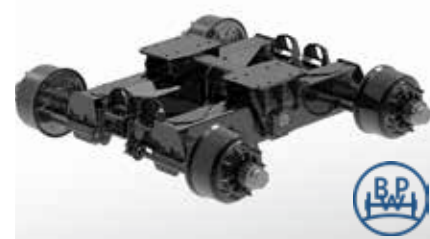
BPW klatna jedinica sa ojačanim osovina kvadrata 150 x 20 mm, kočnica 410 x 180 mm
