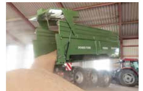
TR 34080/2 PT+ 34 t ukupne težine, sa hidraulično-mehaničkim ili električnim aktivnim upravljanjem po u opciji
