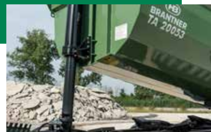
Prednji cilindar tvrdo hromiran za posebno veliku silu podizanja i ugao nagiba preko 50 stepeni
