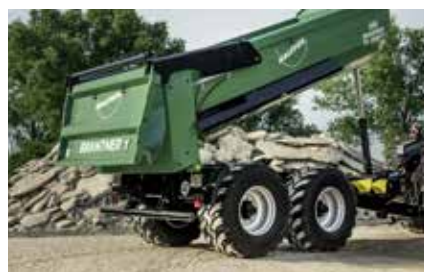
hidraulični klatni poklopac Dabl-ekting hidraulično otvaranje zadnjeg zida sa dvostrukom akcijom
