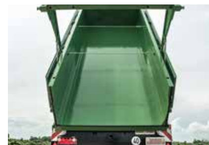
konusni otvor za lakše ispuštanje tereta
