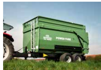
TA 14045/2 PT+ sa 2 cilindra za optimalnu stabilnost kipanja
