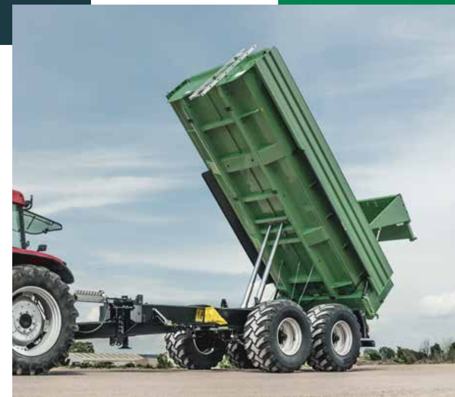
TA 22065/2 XPT+ Jake osovine sa vešanjem od 32 t, ušicom za vuču prirubnice K 80 za opterećenje vučne rude od 4 t
