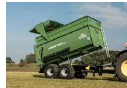
TA 20053/2 PT+ sa konusnim koritom, od čeličnog lima debljine 4 mml
