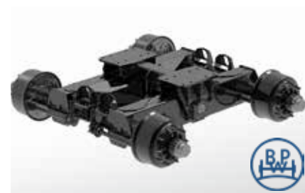
Essieu pendulaire BPW avec axes renforcés profil carré 150 x 20 mm, freins 410 x 180 mm
