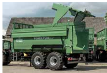
Rehausse rabattables la porte arrière hydraulique peut être ouverte lorsque les parois de rehausse sont rabattues
