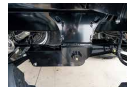
Groupe tandem décalé suspension adaptée pour l'essieu directeur, meilleure stabilité et réduction du roulis
