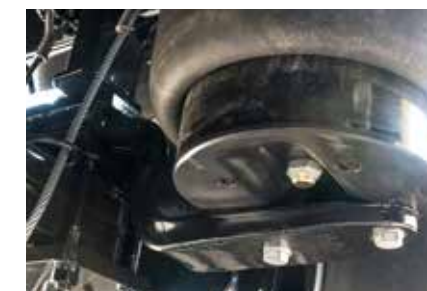
Suspension pneumatique avec bras de guidage à deux lames pour une stabilité optimale et une excellente aptitude au tout-terrain
