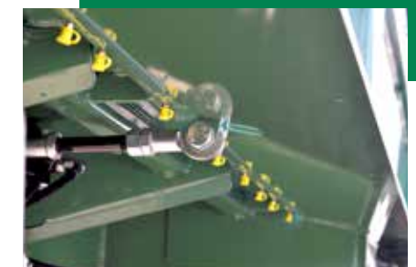
Innovation de Brantner fonction pendulaire à commande hydraulique pour l'ouverture et la fermeture de la paroi latérale
