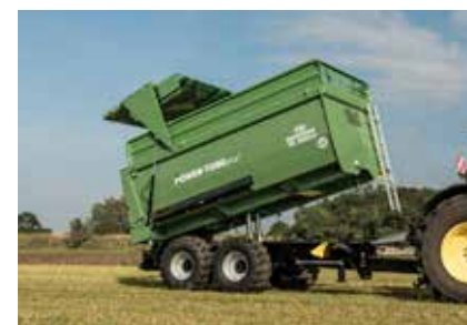
TA 20053/2 PT+ avec auge conique, en tôle d'acier continue de 4 mm d'épaisseur
