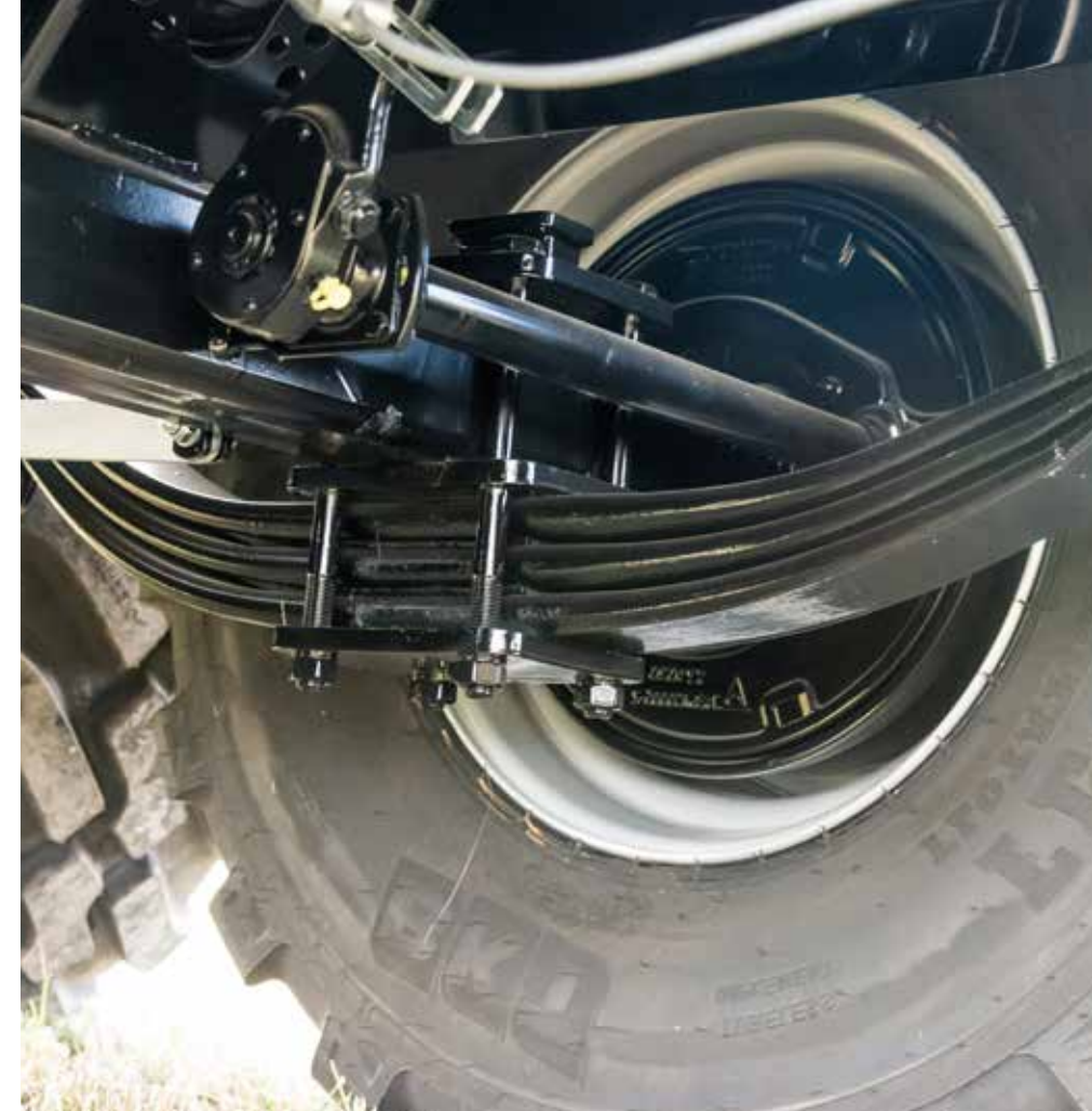
Suspension 32 t avec balancier de compensation renforcé
