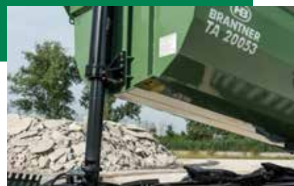
Vérin frontal chromé dur pour une force de levage particulièrement élevée et un angle de basculement supérieur à 50 degrés
