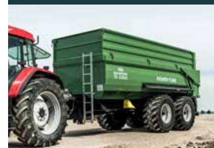
TA 22053/2 XPT+ entièrement en acier de 6 mm d'épaisseur, hauteur 1000 mm
