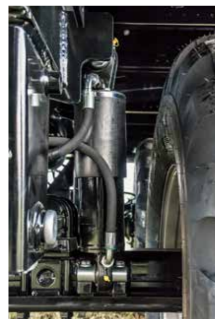
Hydraulické odpružení pro maximální stabilitu v zatáčkách a svahu
