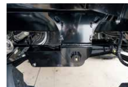
Vyrovnávací odpružení tandemové jednotky přizpůsobené řízené nápravě, lepší stabilita a snížení sklonu k přetáčení
