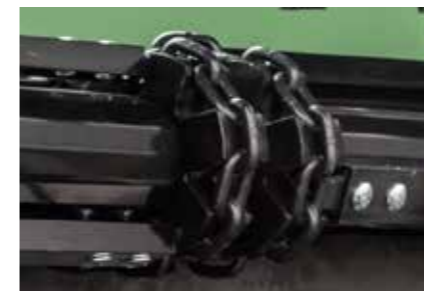
6ti hvězdičkové řetězové kolo pro snížení opotřebení řetězu škrabky
