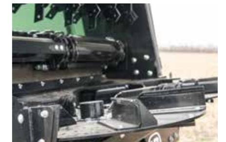
Rozmetací deska z 10 mm Hardoxu a 6ti nastavitelnými rozmetacími lopatkami
