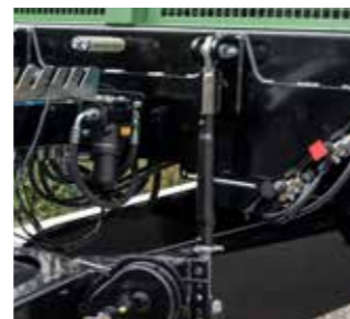
Výška nástavce nastavitelná pomocí vřeten
