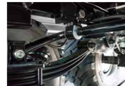
Pružinový stabilizátor je vysoce doporučen pro řízené nápravy (možno pouze s parabolickým odpružením)
