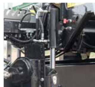
volitelná opce- hydraulicky odpružená oj
