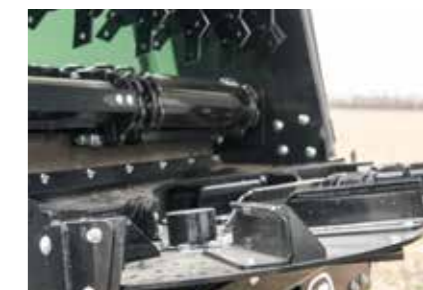
Rozmetací deska z 10 mm Hardoxu a 6ti nastavitelnými rozmetacími lopatkami
