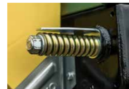
BRANTNER prednost automatski zatezač lanca u standardu
