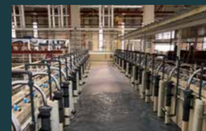
KTL i predtretman 12 procesa uranjanja za hemijsko čišćenje i naknadno nanošenje KTL premaza
