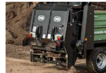
Univerzalni rasipač komposta CL2-2 sa dva horizontalna valjka za glodanje i diskovima za posipanje
