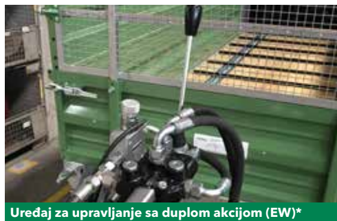
Uređaj za upravljanje sa duplom akcijom (EW)*
