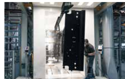
Jedinstveni katodno potapajući tretman i praškasto farbanje idealna zaštita od korozije
