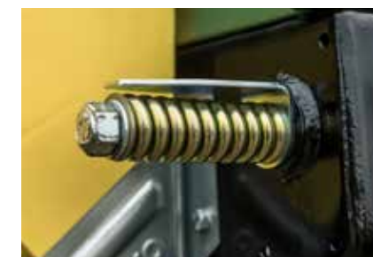
BRANTNER prednost automatski zatezač lanca u standardu
