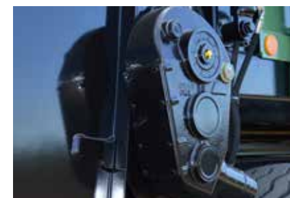
Transportni pod sa robusnim zupčastim menačima u uljanoj kadici na svim Brantner
