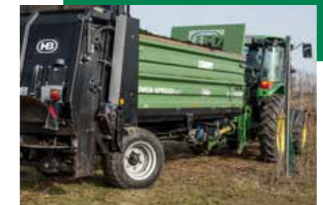
Inovacija Brantnera, opcionalna hidraulična upravljačka osovina
