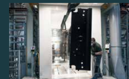
Automatsko farbanje nanošenjem praha
