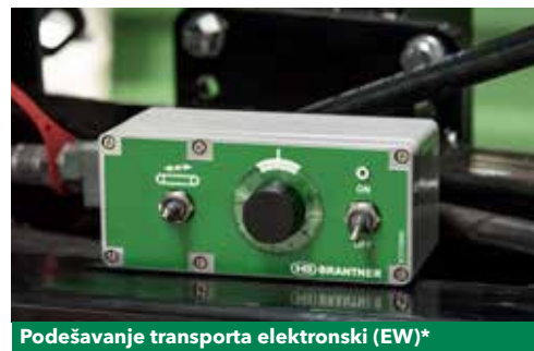
Podešavanje transporta elektronski (EW)*
