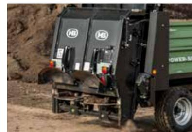
Unidad esparcidora universal, el esparcidor de compost CL2-2 con dos rodillos de fresado horizontales y discos esparcidores
