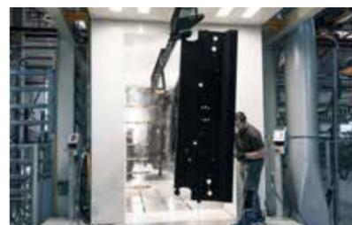
Único recubrimiento por inmersión catódica y recubrimiento en polvo, protección ideal contra la corrosión
