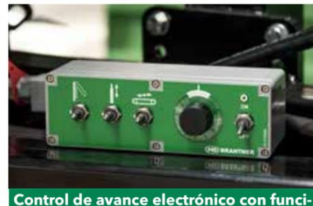
Control de avance electrónico con función adicional para muro de contención y protección de la unidad esparcidora
