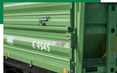
Cierres para montaje y desmontaje rápido
