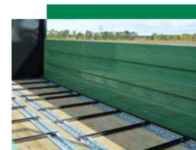
Rieles del suelo raspador hechos de acero en U de alta resistencia (40 x 20 mm), atornillados con cadena
