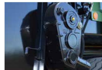
Accionamiento continuo del suelo raspador, una caja de cambios robusta montada en baño de aceite en todos los esparcidores Brantner
