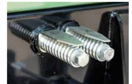
Tensor de cadena Tensor de cadena automático con indicador en la pared frontal
