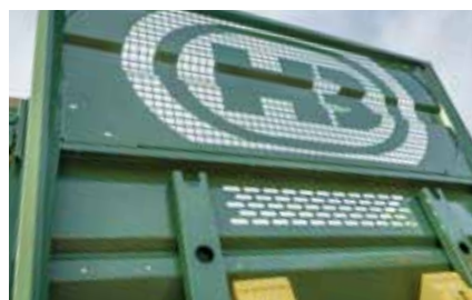
Velika zaštitna rešetka štiti od lomljenja kamena i nudi optimalnu preglednost u tovarnom prostoru
