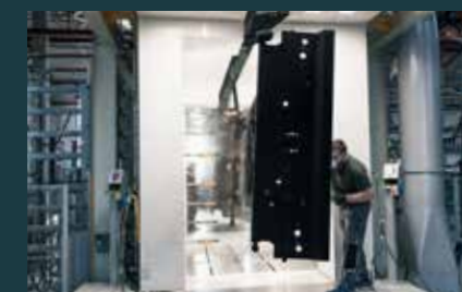
Automatsko farbanje nanošenjem praha
