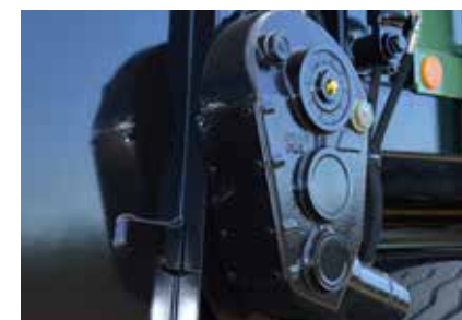
Transportni pod sa robusnim zupčastim menačima u uljanoj kadici na svim Brantner
