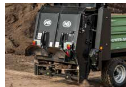
Univerzální rozmetadlo rozmetadlo kompostu CL2-2 se dvěma horizontálními řezacími válci a rozmetacími talíři
