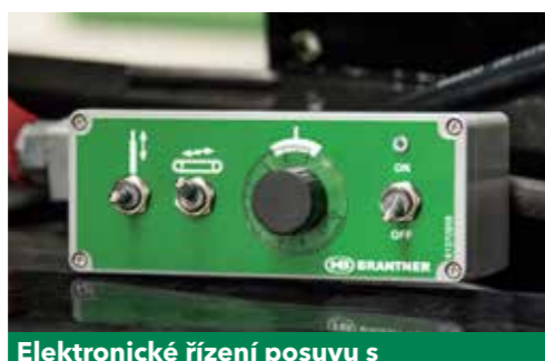
Elektronické řízení posuvu s doplňkovou funkcí pro ochranu opěrné zdi nebo rozmetadla
