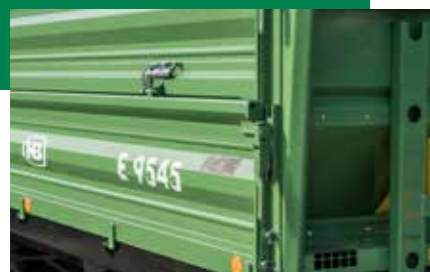
Zámky pro rychlou montáž a demontáž
