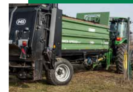
Inovace od Brantner volitelně hydraulicky řízená náprava
