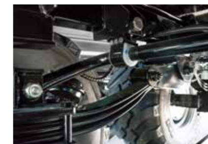
Opružni stabilizator se preporučuje za upravljačke osovine (moguće samo sa paraboličnim ogibljenjem)
