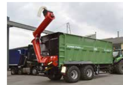
Hidraulički sklopivi pretovani puž, sa poprečnim pužem
