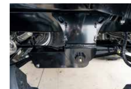
Offset tandem jedinica suspenzije prilagođena za upravljačku osovinu, bolju stabilnost i smanjenje sklonosti kotrljanja
