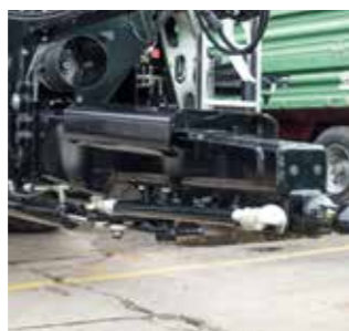
Hidraulično-mehaničko prinudno upravljanje
