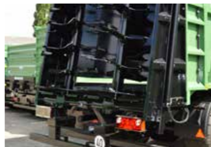
Jedinica za širenje sa dva vertikalna bubnja za mlevenje visokih performansi, pričvršćenim ojačanim zupcima za mlevenje od Hardoks/Quad čelika
