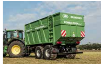
TA 20055 PP+ standard sa bočnim pločama od 2000 mm
