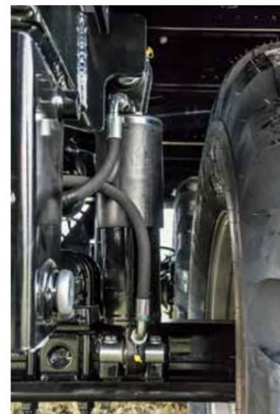
Suspensión hidráulica para máxima estabilidad en curvas y pendientes
