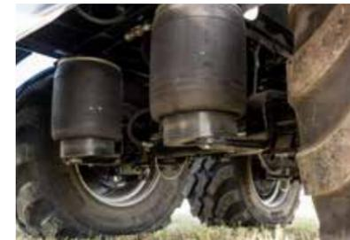
Suspensión Varios sistemas posibles, por ejemplo, suspensión neumática o suspensión hidráulica
