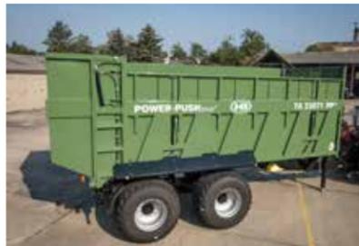
**Pared de elevación retráctil lateralmente, controlada hidráulicamente**
