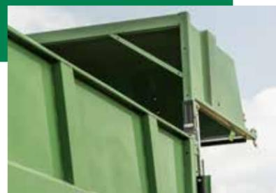
**Pared trasera hidráulica, volumen de carga adicional debido a la pared trasera profunda.**
