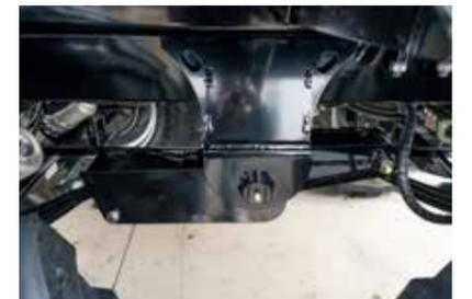
unidad tandem Suspensión de unidad tandem desplazada ajustada para el eje de dirección, mejor estabilidad y reducción de la tendencia a volcarse
