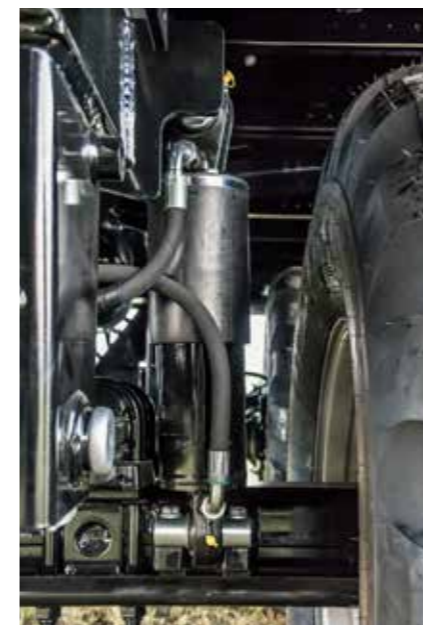
Hydraulikfederung höchstmögliche Kurven- und Hangstabilität
