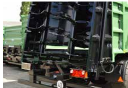
Streuwerk mit zwei vertikalen Hochleistungsfräs- walzen, aufgeschraubte verstärkte Fräszinken aus Hardox/Quard-Stahl
