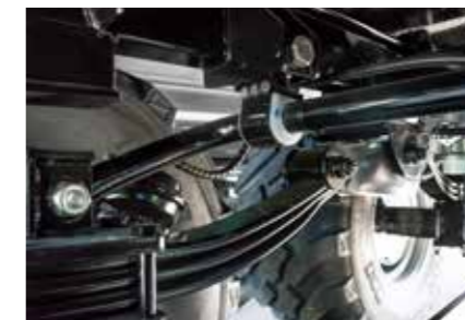
Federstabilisator sehr zu empfehlen bei Lenkachse (nur bei Parabelfederung möglich)
