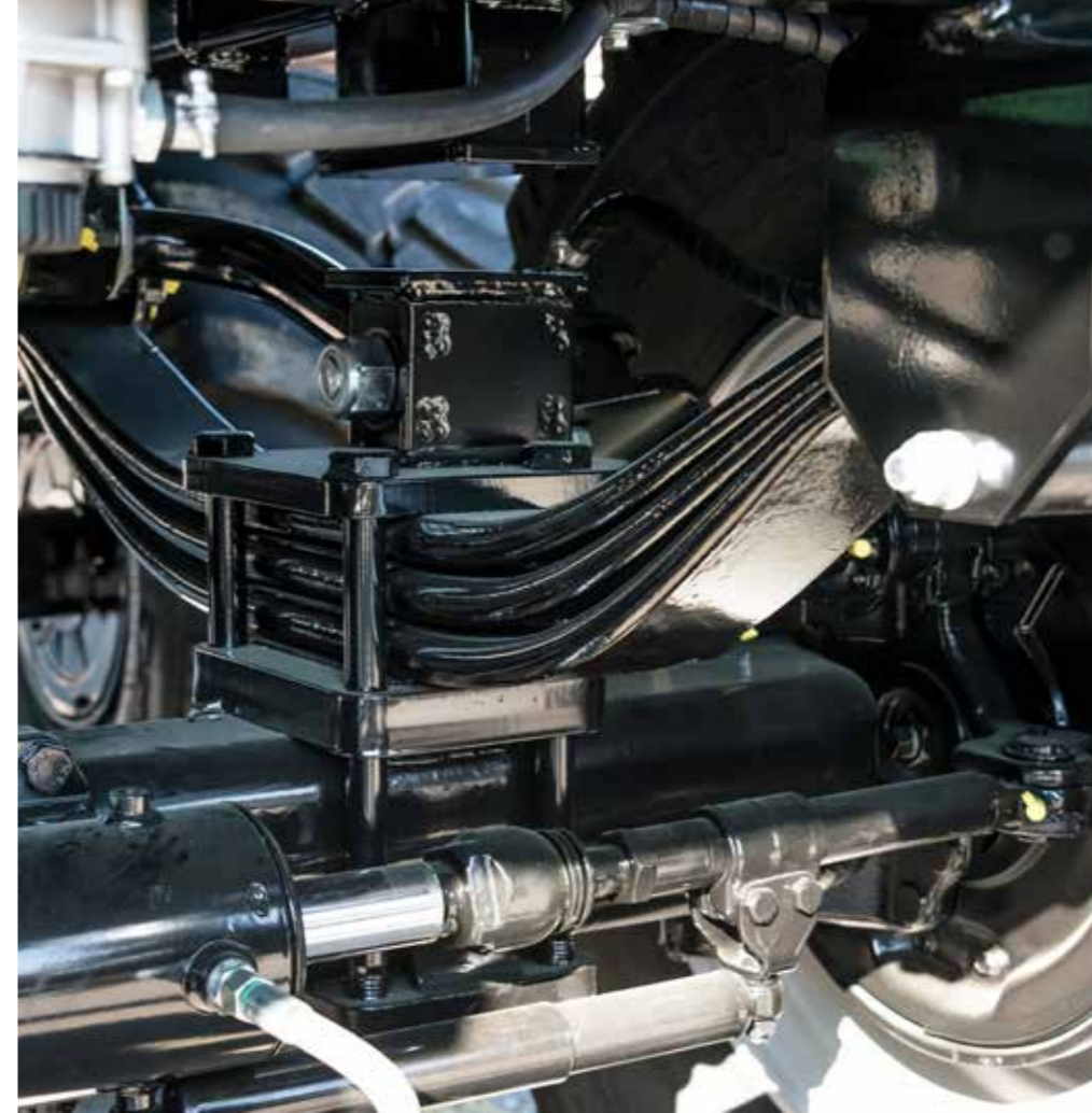
32 to Federaggregat mit verstärkter Ausgleichswippe
