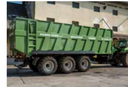
TR 34090 PP+ Tridem Fahrwerk, 34 to GesGew., 43 oder 49 m 3 Ladevolumen
