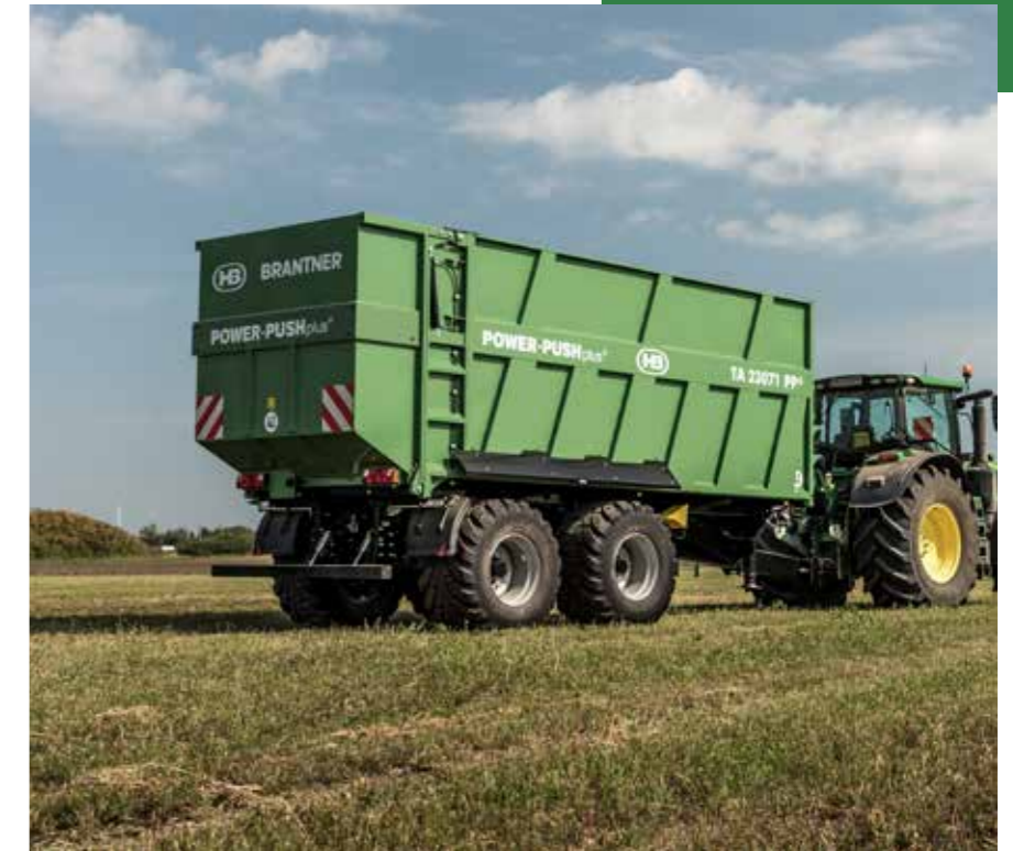
TA 23071 PP+ optional mit hydraulisch abklappbaren Unterfahr- schutz hinten
