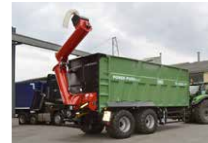
Überladeschnecke hydraulisch klappbar, mit Querförderschnecke
