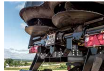
Stapleraufnahme einfache Montage mit Stapler/Teleskopklader
