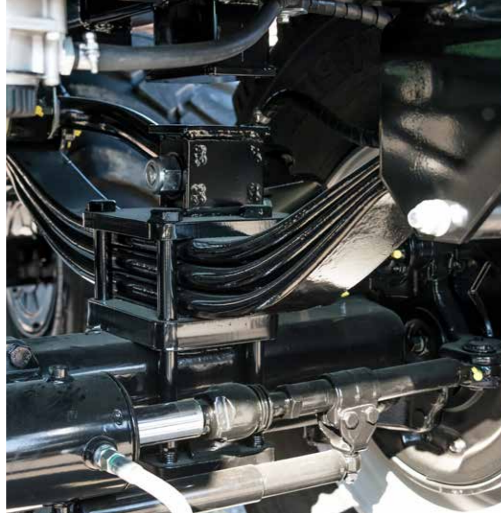
32 ton fjederenhed med forstærket balanceringsvippe
