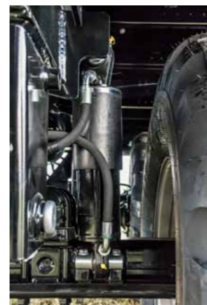
Hydraulisk affjedring Maksimal stabilitet i sving og på skråninger
