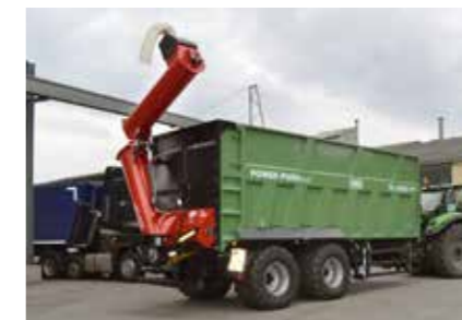
Tømmesnegl Som hydraulisk sammenklappelig med tværtransportsnegl
