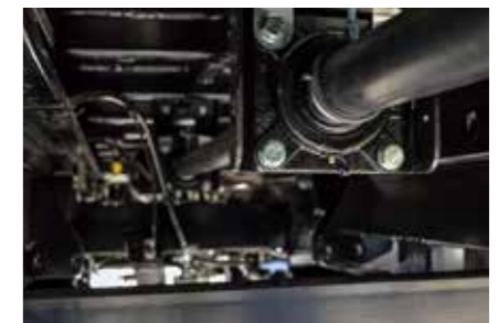
PTO driv-line til spredner og tømmesnegl
