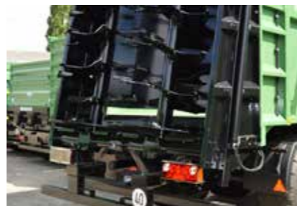
Spredningsaggregat Med to vertikale højtydende spredeaksler, monteret med spredeplader produceret i Hardox/Quad-stål
