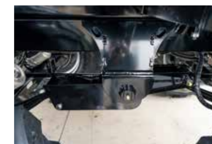
Forskudt tandem aksel Affjedring på styrende aksel for bedre stabilitet ved kørsel og tipning
