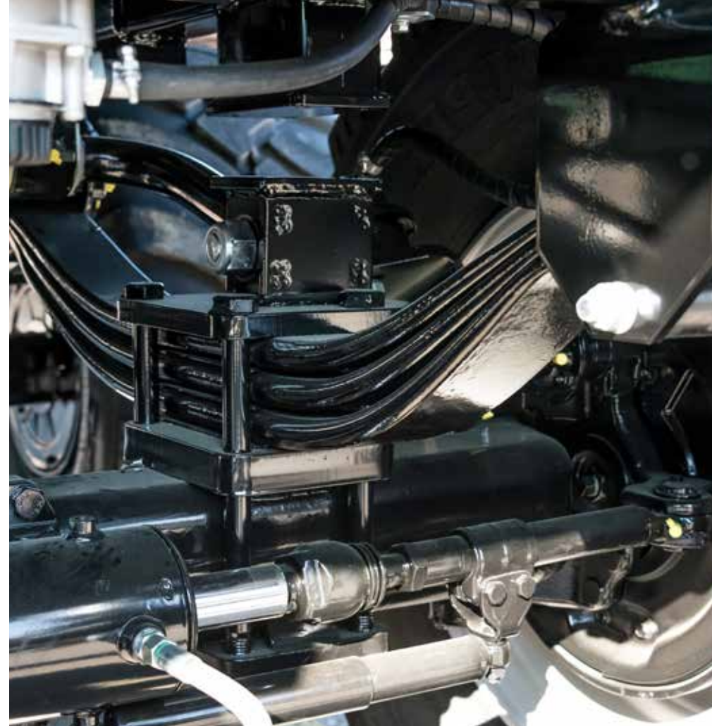
32 t pružinová jednotka se zesílenou vyrovnávací jednotkou
