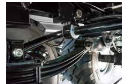
Pružinový stabilizátor silně doporučován pro řízené nápravy (možno pouze s parabolickým zavěšením)
