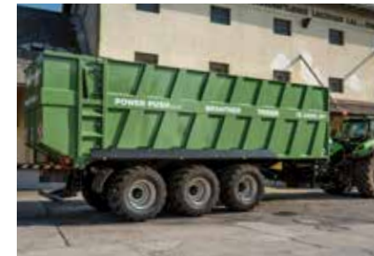
TR 34090 PP+ třínápravový podvozek, celková hmotnost 34 t, ložný objem 43 nebo 49 m 3
