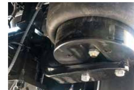
Vzduchové odpružení s dvoučlenným článkem pro optimální stabilitu a mobilitu v terénu
