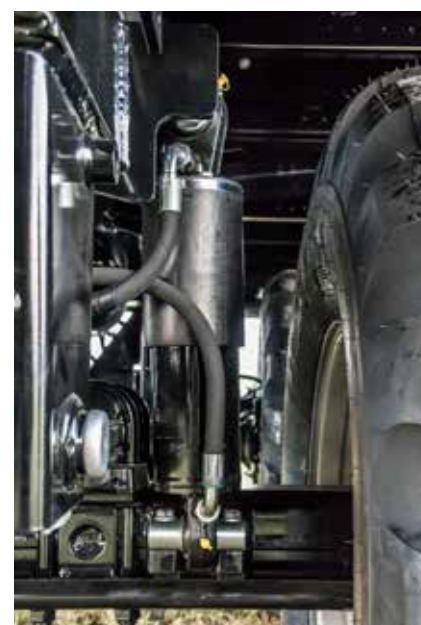
Hydraulické odpružení maximální stabilita v zatáčkách a na svahu
