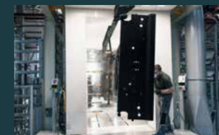
Automatické práškové lakování
