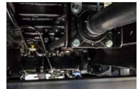
PTO pogon za montažu rasipača ili pretovarnog puža
