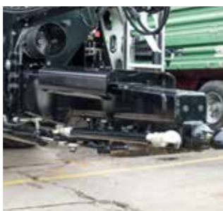
Hidraulično-mehaničko prinudno upravljanje
