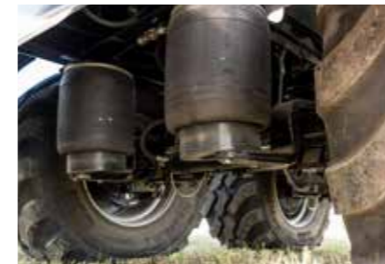
Moguća suspenzija raznih sistema, npr. vazdušno ili hidraulično vešanje
