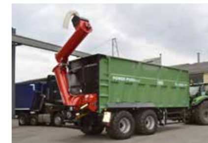
Hidraulički sklopivi pretovarni puž, sa poprečnim pužem
