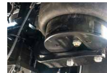
Vazdušno oslanjanje sa dvokrilnim karikama za optimalnu stabilnost i pokretljivost van puta
