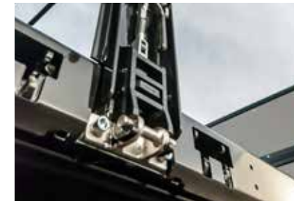
skidanje srednjeg stuba bez alata, opcija za lakše tovarenje kutija i paleta
