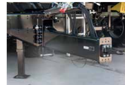
Ruda podesiva po visini od dupli-C-profila, za kačenje gore ili dole
