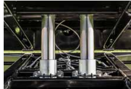
Cilidar za kpanje tvrdo hromiran sa kardanskim ležajem u izvedbi jedan ili dva komada
