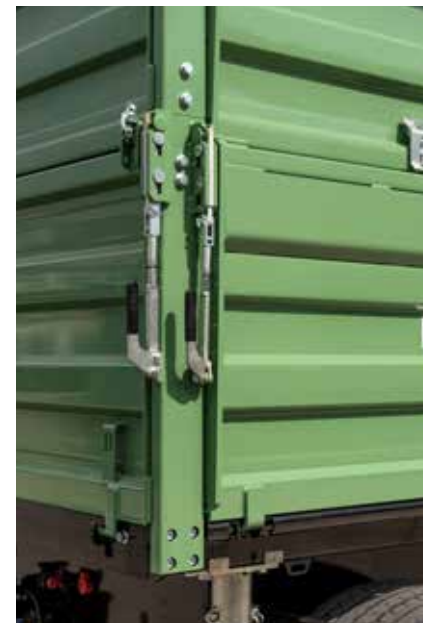
HB-kamionski zatvarači komforno upravljanje na optimalnoj visini
