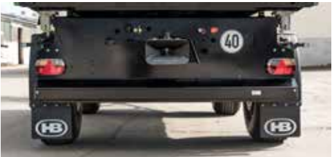
Multi-Point rasveta sa gumenom zaštitom od prskanja
