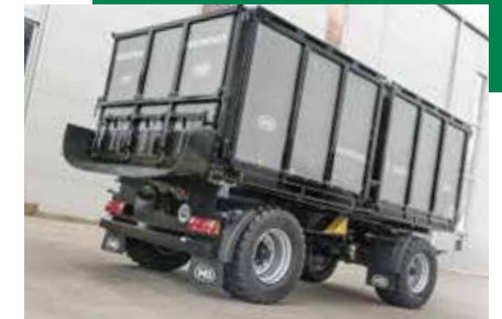
tobogan za lakši istovar osetljivog materijala (npr. krompir)
