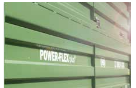
Ojačanje stranice od 6mm čeličnog lima i kutijastim profilom, fiksno zavareno
