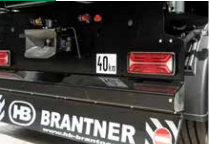
serijska rasveta sa Agriled LED stop svetlom sa otporom i migavcem
