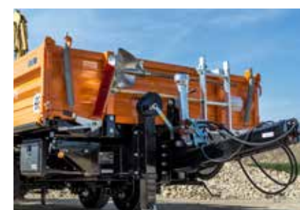
TA13045 niskopodna prikolica serijski sa po visini podesivom ručdom, i opcionim držačem za metlu i lopatu
