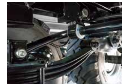
Stabilizator opruge kao opcija, preporučen za upravljive osovine
