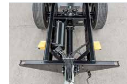
Četvrtasti ram od G ili dupli-C-profila
