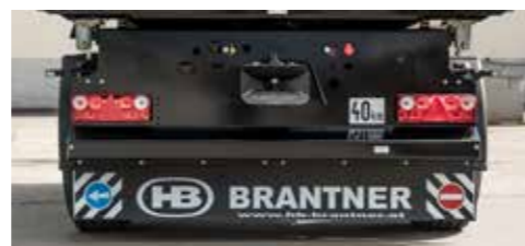
Europoint II rasvjeta sa gumenom zaštitom od prskanja cijelom širinom
