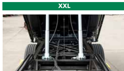
Izvedba sa dva cilindra za kipanje
