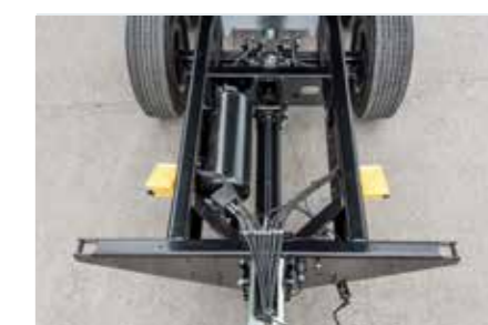
Četvrtasti okvir od G ili dupli-C-profila
