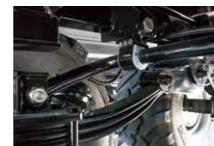
Stabilizator opruge kao opcija, preporučen za upravljive osovine
