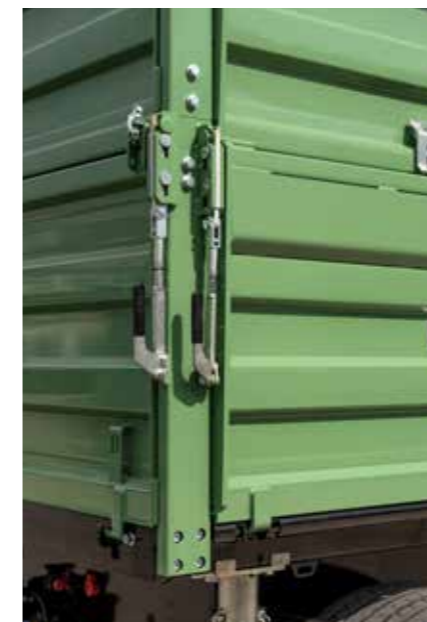
HB-kamionski zatvarači komforno upravljanje na optimalnoj visini
