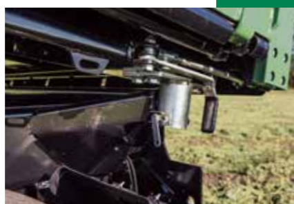
Ležajevi klanja na vanjskoj strani za još više stabilnosti
