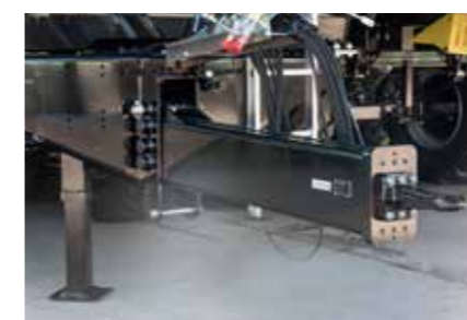
Ruda podesiva po visini od dupli-C-profila, za kopčanje gore ili dolje
