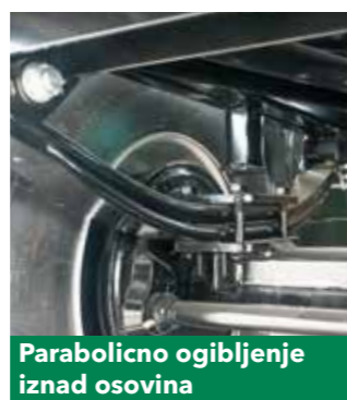
Parabolično ogibljenje ispod osovina
