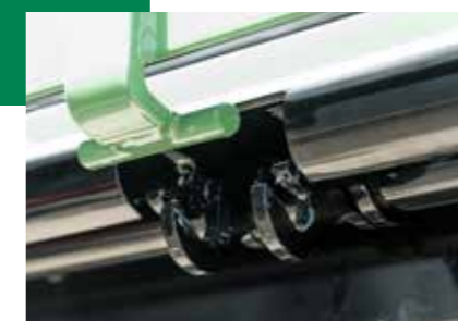
Zakačke stranice sa duplim kopčanjem na vozilima preko 5m poda
