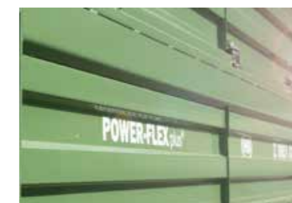
Ojačanje stranice od 6mm čeličnog lima i kutijastim profilom, fiksno zavareno
