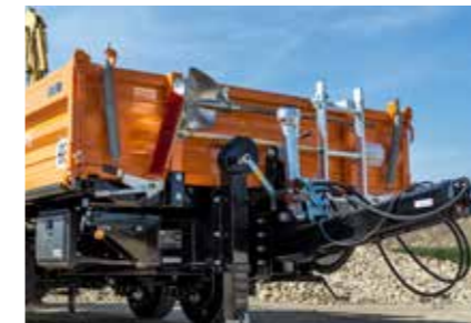
TA13045 serijski niskopodna te prema visini podesivom rudom, i opcionim držačem za metlu i lopatu
