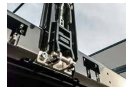
skidanje srednjeg stupa bez alata, opcija za lakši utovar kutija i paleta
