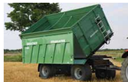
glatke unutrašnje stranice sa konusnom platformom i potpuno glatkom površinom unutrašnjih stranica olakšavaju isklizavanje materijala
