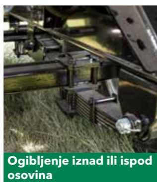
Parabolično ogibljenje iznad osovina
