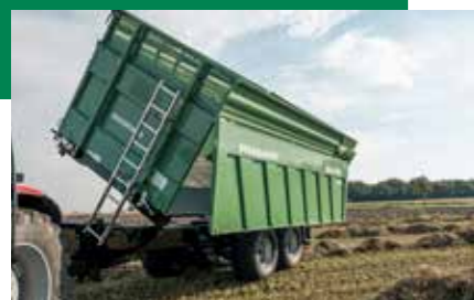
Klateća stranica na ležaju lijevo i desno, jednostavno otvaranje.
