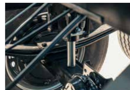
Hidraulično oslanjanje zadnje osovine serijski za optimalan komfor vožnje
