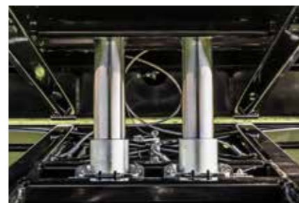
Cilindar za klanje tvrdo kromiran sa kardanskim ležajem u izvedbi jedan ili dva komada
