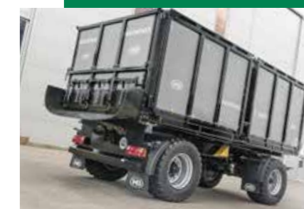
ispust za lakši istovar osjetljivog materijala (npr. krumpir)
