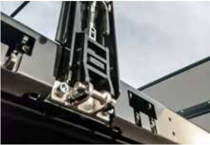
Columna central desmontable sin herramientas – bajo pedido, útil para cargar cajas o pallets
