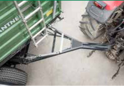
Barra de tracción en Y para radios de giro extremos
