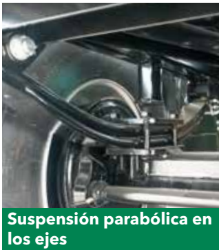
Suspensión parabólica en bajo los ejes
