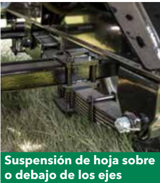
Suspensión parabólica en los ejes
