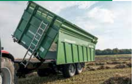
Pared pendular Paredes pendulares estabilizadoras a izquierda y derecha, fáciles de abrir
