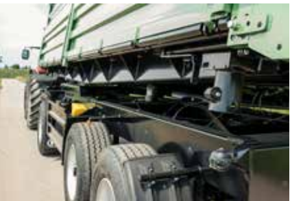
Bastidor basculante trapezoidal según el diseño de camión con rodamientos de inclinación hacia el exterior
