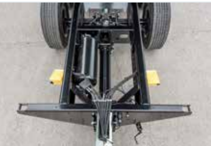
Marco rectangular de perfiles G o doble C prensado
