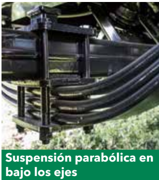
Suspensión parabólica en los ejes
