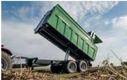
Pared trasera hidráulica Opcionalmente con pared trasera hidráulica
