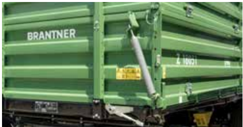
Muelle de elevación de pared lateral simple
