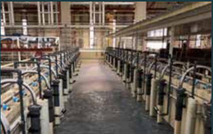
KTL y pretratamiento 12 procesos de inmersión para limpieza química y posterior recubrimiento KTL
