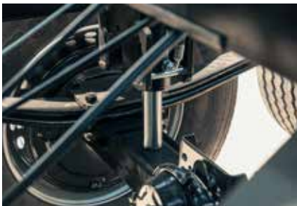
Soporte hidráulico del eje trasero estándar para un confort óptimo de la suspensión
