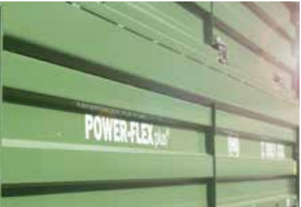
Refuerzo del aparador De chapa de acero de 6mm con perfil de caja soldado
