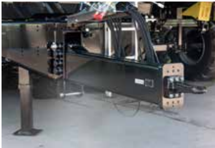
Barra de tracción regulable en altura con perfiles prensados doble C para acoplamiento superior e inferior
