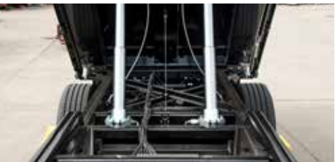
Versión con dos cilindros de vuelco
