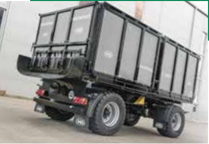
Deslizador Para la descarga óptima de productos sensibles (por ejemplos patatas)
