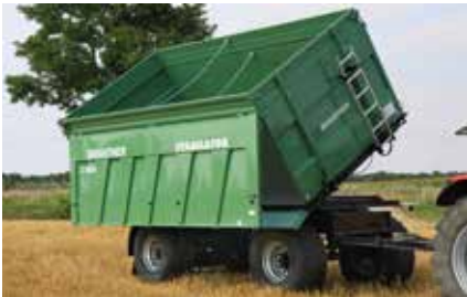
Paredes interiores lisas La placa cónica y las paredes interiores lisas permiten que la carga se deslice fácilmente
