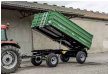
Z 8045 XXL Con freno de inercia y paredes de fijación de 500 mm
