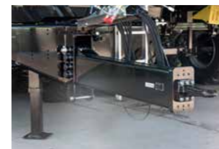
Výškově stavitelné tažné zařízení z dvojitých C lisovaných profilů, jako horní a spodní uchycení
