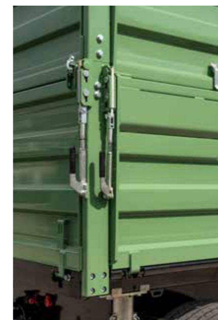
HB-uzávěr ze sektoru nákladních vozů zajišťuje komfortní ovládání v optimální pracovní výšce
