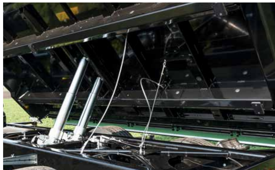
Trapézový sklápěcí rám ze sektoru nákladních automobilů včetně výztužných žebér
