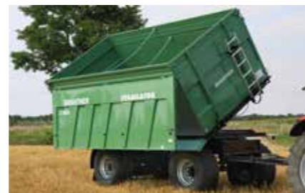
hladké vnitřní stěny, kónická plocha podlahy a absolutně hladké vnitřní stěny umožňují snadné sklouznutí nák-
