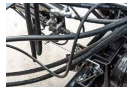
Pneumatické ALB zařízení zajišťuje správné nastavení brzdné síly
