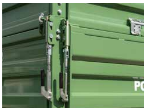
HB - zámky ze sektoru nákladních aut, s vyztužením bočnic
