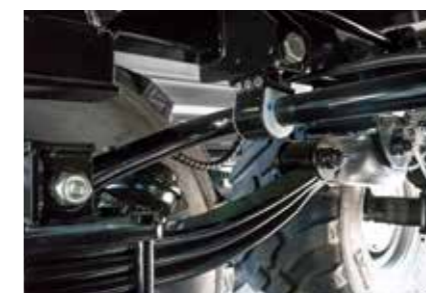
Pružinový stabilizátor dostupný jako volitelná výbava, doporučený pro řízené nápravy
