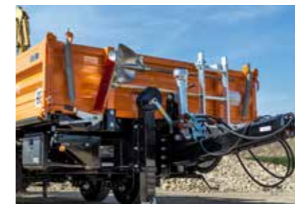
Podvalník TA 13045 standardně s výškově nastavitelnou ojí, volitelně k dispozici držák lopaty kartáče
