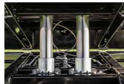
Tvrdo chromovaný vyklápěcí válec s kardanovým závěsem jeden nebo dva kusy v závislosti na verzi
