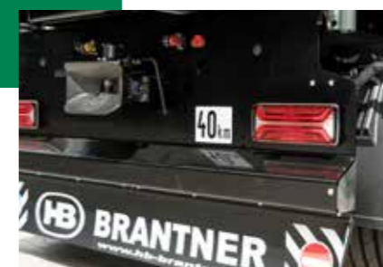
Standardní osvětlení se zadním světlem Agriled full LED s odporem pro blinky
