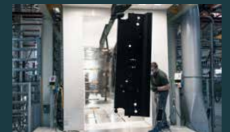
Automatické práškové lakování
