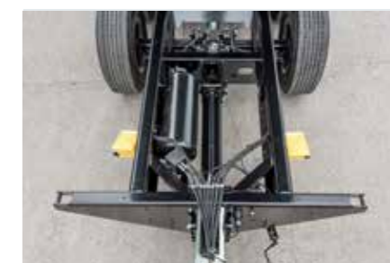
Obdélníkový rám z lisovaných profilů G nebo dvojitých C profilů
