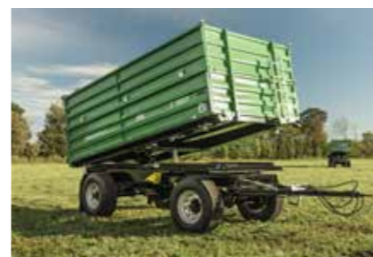
Z 18051 SPECIÁLNÍ NABÍDKA základní model v osvědčené kvalitě Brantner se standardním rámem z lisovaného dvojitého C profilu
