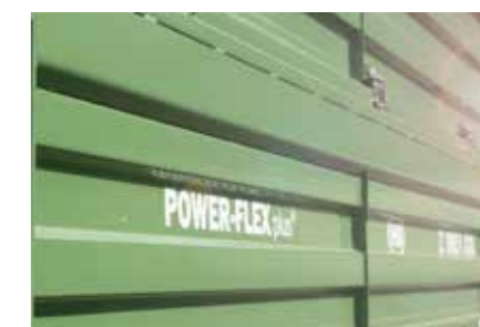
Výztuhy bočních stěn z 6 mm ocelového plechu se skříňovým profilem, trvale svařované
