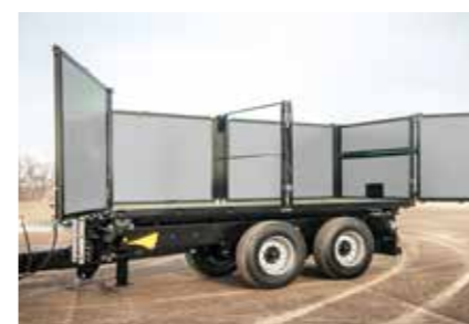
Portalna vrata serijski portalna vrata levo (opcija moguća i desno), ležajevi
