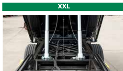
Izvedba sa dva cilindra za kipanje
