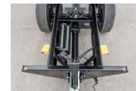
Četvrtasti ram od G ili dupli-C-profila
