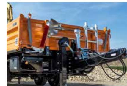
TA13045 niskopodna prikolica serijski sa po visini podesivom rudom, i opcionim držačem za metlu i lopatu
