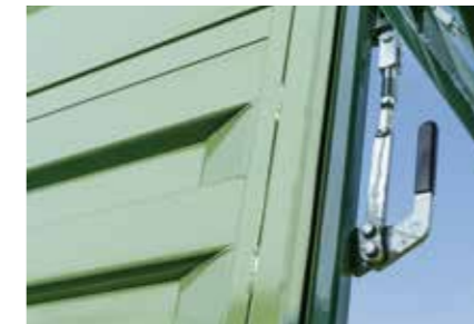
Metalni lavirintski zaptivač na subovima u čoškovima za zadnje stranice
