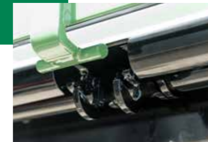
Šarniri stranica sa duplim kačenjem na vozilima preko 5m poda
