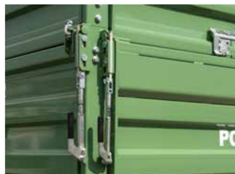
HB-kamionski zatvarači, sa ojačanjem stranica
