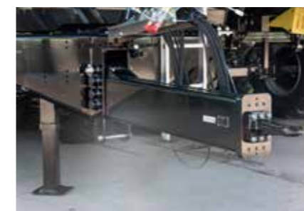
Ruda podesiva po visini od dupli-C-profila, za kačenje gore ili dole
