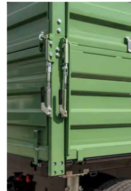
HB-kamionski zatvarači komforno upravljanje na optimalnoj visini
