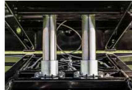
Cilindar za klanje tvrdo hromiran sa kardanskim ležajem u izvedbi jedan ili dva komada
