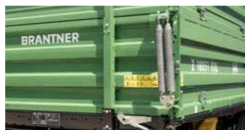
dupla opruga, na okretnim ležajevima
