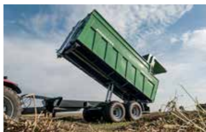
opcionalna hidraulička zadnja vrata
